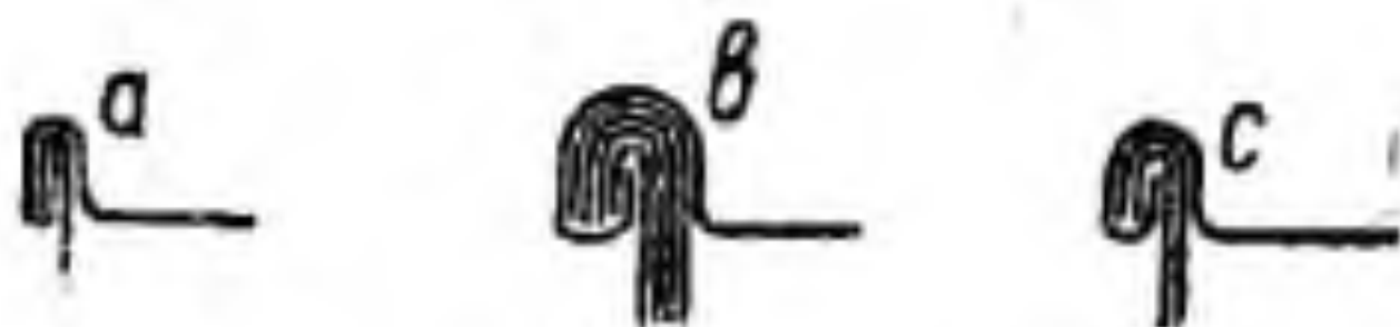
Рис. 20. Поперечный закаточный шов.
