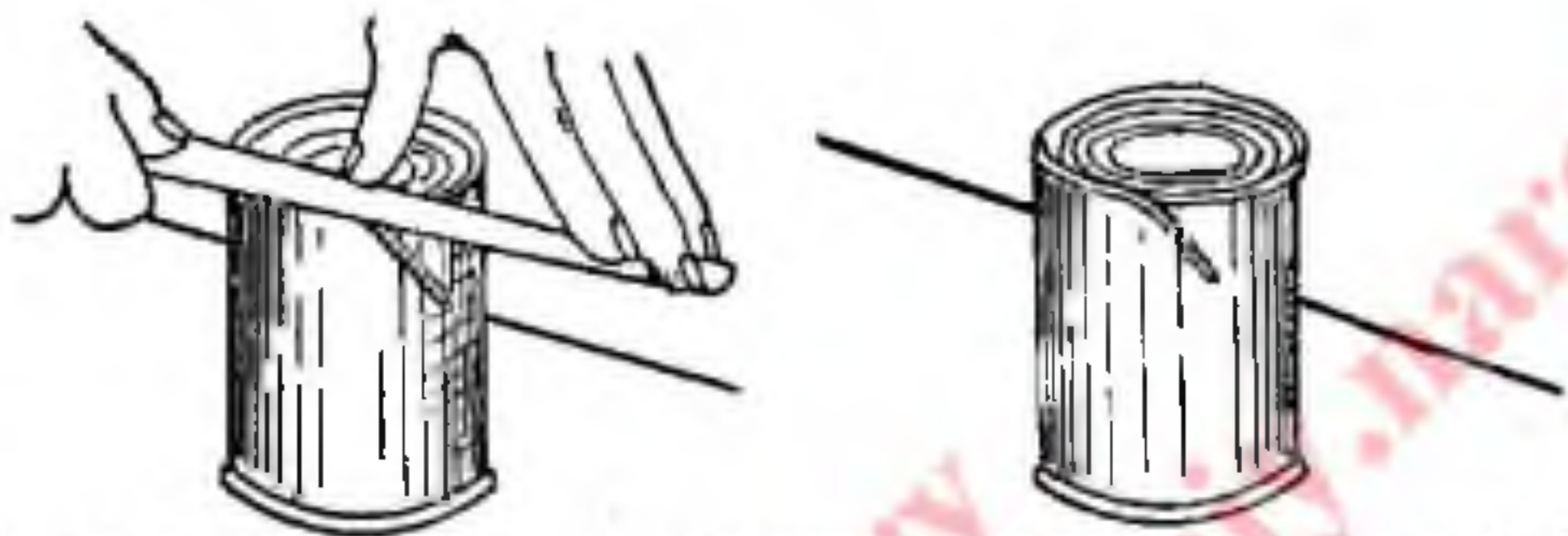
Рис. 33. Способы открытия двойного шва банок для контроля работы закаточных машин.
