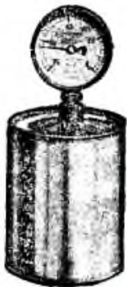
Рис. 42. Вакуумметр для определения вакуума в банке.
