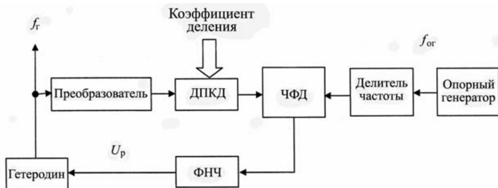
Рис. 4.3. Обобщенная структурная схема цифрового синтезатора частоты с переменным коэффициентом деления (ДПКД), а требуемая величина коэффициента деления заносится в него по цифровой шине управления обычно от микроконтроллера системы управления радиоприемником. Вся указанная обработка осуществляется цифровым способом, поэтому необходимо предварительное преобразование гармонического сигнала гетеродина в последовательность импульсов той же частоты, а также обратное преобразование выходного импульсного сигнала ЧФД в аналоговый сигнал. Последнюю функцию выполняет фильтр нижних частот (ФНЧ).
