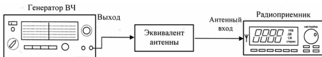
Рис. 7.2. Схема подачи ВЧ сигнала через эквивалент антенны
