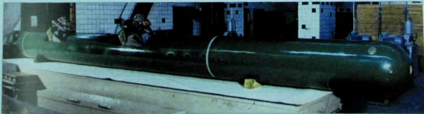
Самоходное автономное средство доставки водолазов «Сирена»
