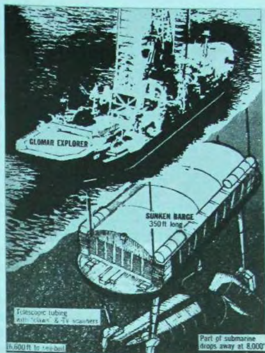
Схема подъема пл К-129 судном «Гломар Эксплорер» по плану операции «Дженифер»
