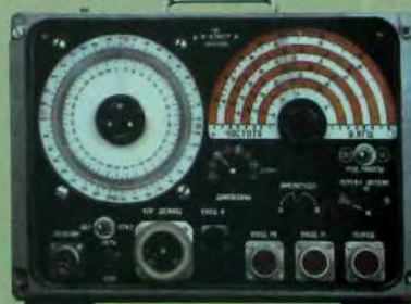
Радиоприемник Р-671 «Хмель» (слева)
