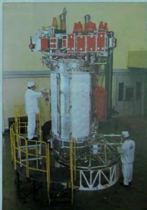
Сборка навигационного спутника ГЛОНАСС-М
