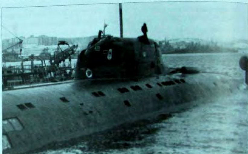
11 февраля 1992 г., повреждения на апл К-276 (пр. 945) после столкновения с п/ла «Батон Руж» ВМС США в Баренцевом море
