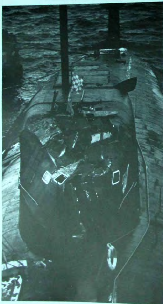
11 февраля 1992 г., повреждения на апл К-276 (пр. 945) после столкновения с п/ла «Батон Руж» ВМС США в Баренцевом море
