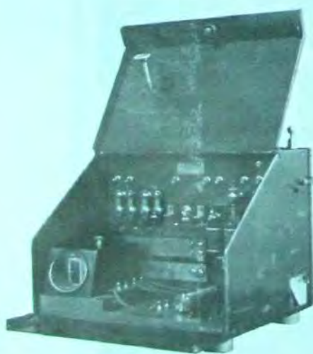
Радиоприемник системы А.С. Попова времен русско-японской войны (для приема на ленту). Производство фирмы «Дюкрете»
