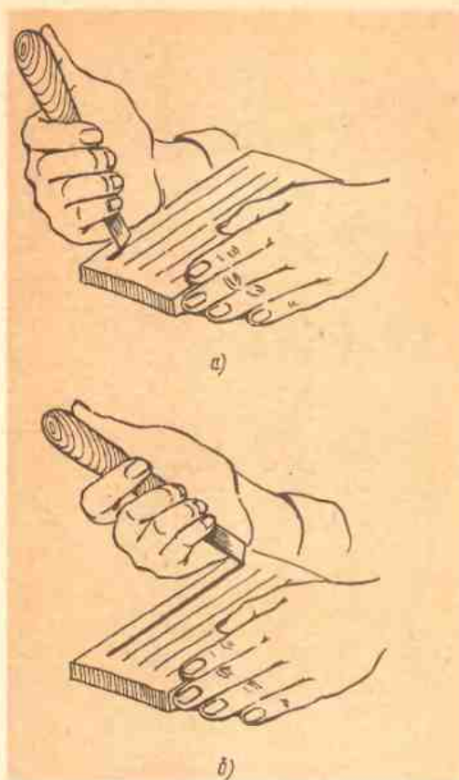
Рис. 83. Положение резака и рук резчика в начале резьбы линий (а) и в конце резьбы линий (б)
