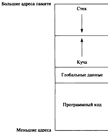
Рис. 12-1. Принципиальная схема распределения памяти для C++-программы
