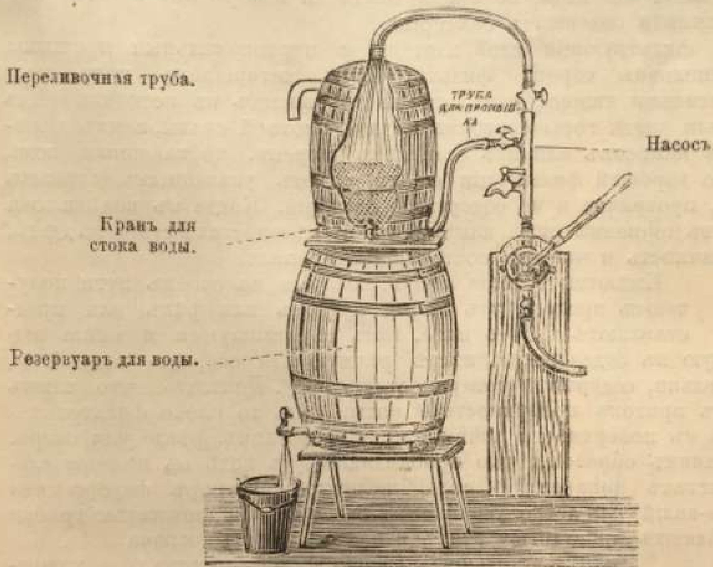
Рис. 34. Фильтръ для удаленія изъ воды желѣза съ насосомъ по Dunbar'у.
