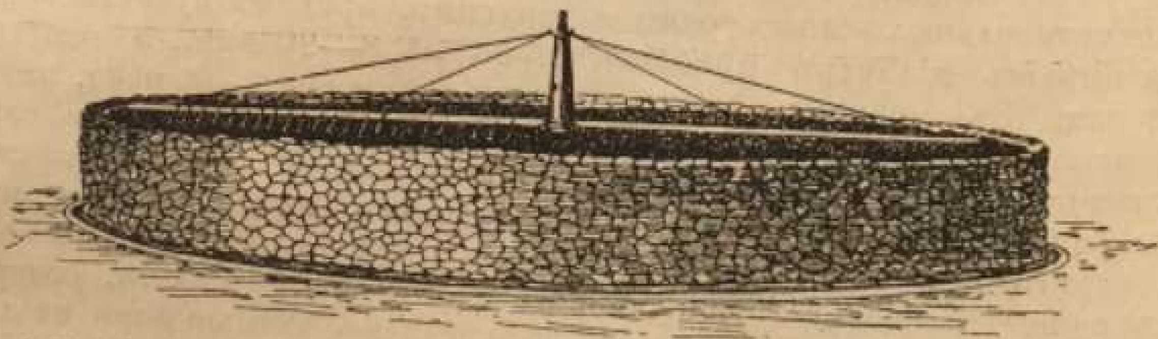
Рис. 148. Устройство для биологической очистки по капельному способу. Коксовая башенка высотой въ 2 м., съ распределителемъ грязной воды и плоской, окружающей башенку канавкой для отвода очищенной воды.
