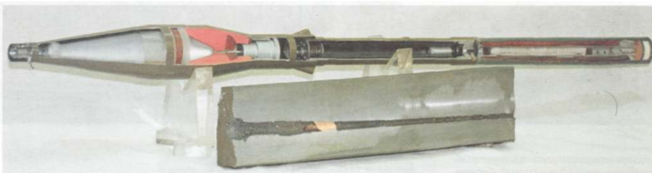
Разрез выстрела ПГ-7ВС, рядом фрагмент 400-мм листа брони, пробитого гранатой ПГ-7С.
