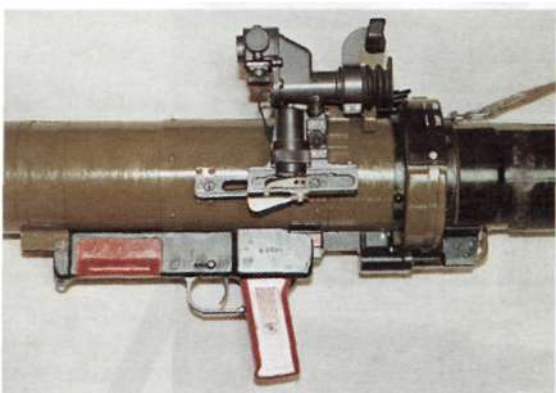
Прицел и спусковой механизм РПГ-29.
