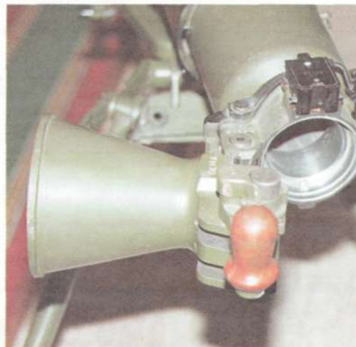
Затвор СПГ-9М в открытом положении.
