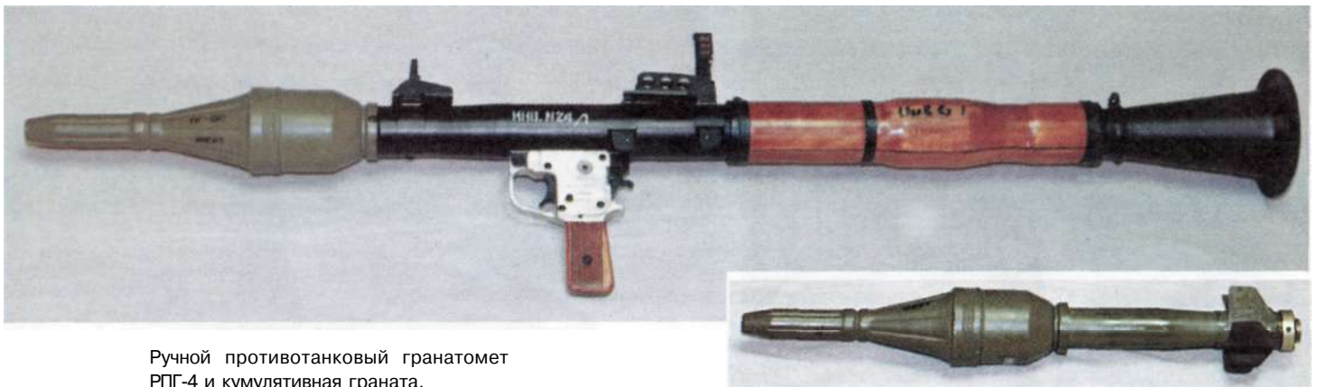
Механический прицел гранатомета РПГ-4.
