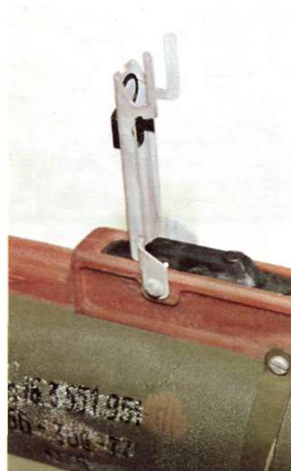
Прицел и спусковой механизм РПГ-22.
