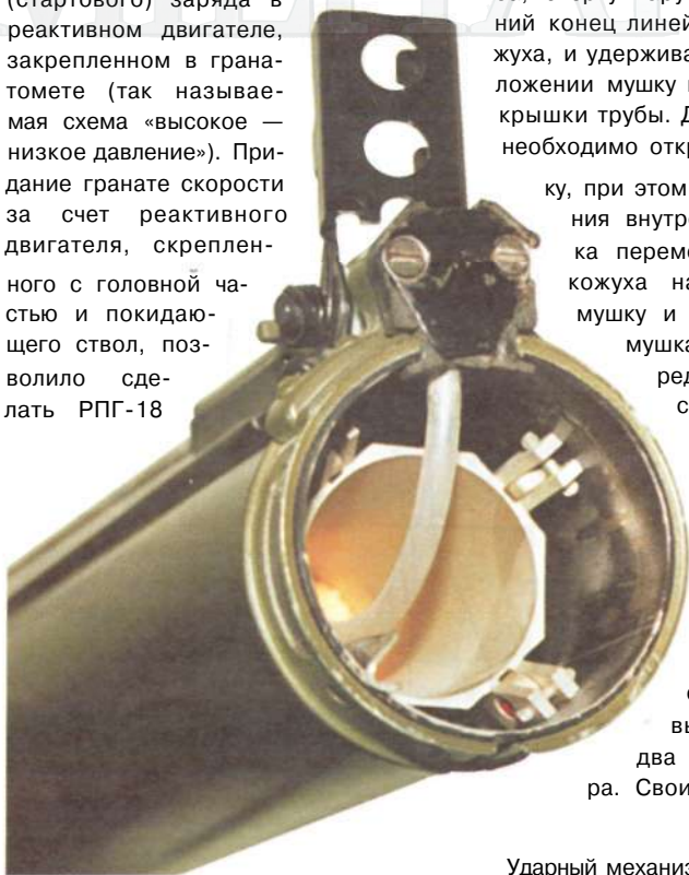
Ударный механизм и газовод РПГ-18.
