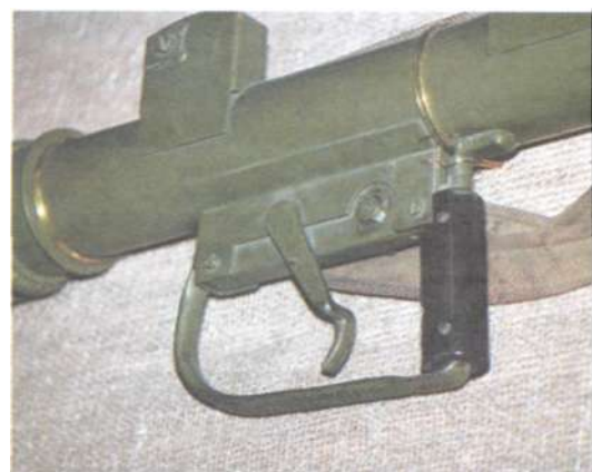
Спусковой механизм ружья «ПИАТ».
