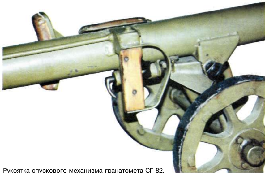
Рукоятка спускового механизма гранатомета СГ-82.
