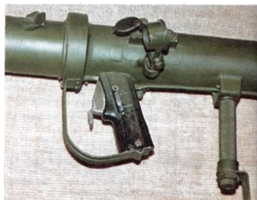
Спусковой механизм и прицел ружья М.18.
