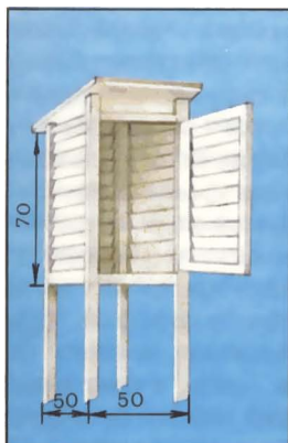
Метеорологическая будка Указаны размеры в сантиметрах.
