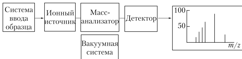
Рис. 6.1. Схема масс-спектрометра
