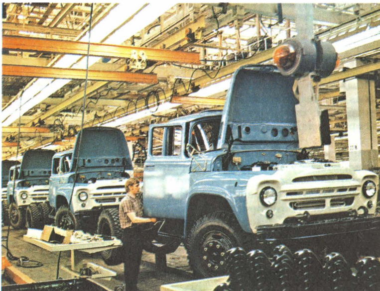
Главный конвейер Московского автомобильного завода имени И. А. Лихачёва. Фотография. 1979 г.
