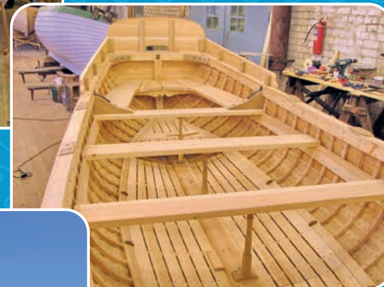
По размерам и конструкции «Дедушка русского флота» очень близок к шлюпке ЯЛ-6
