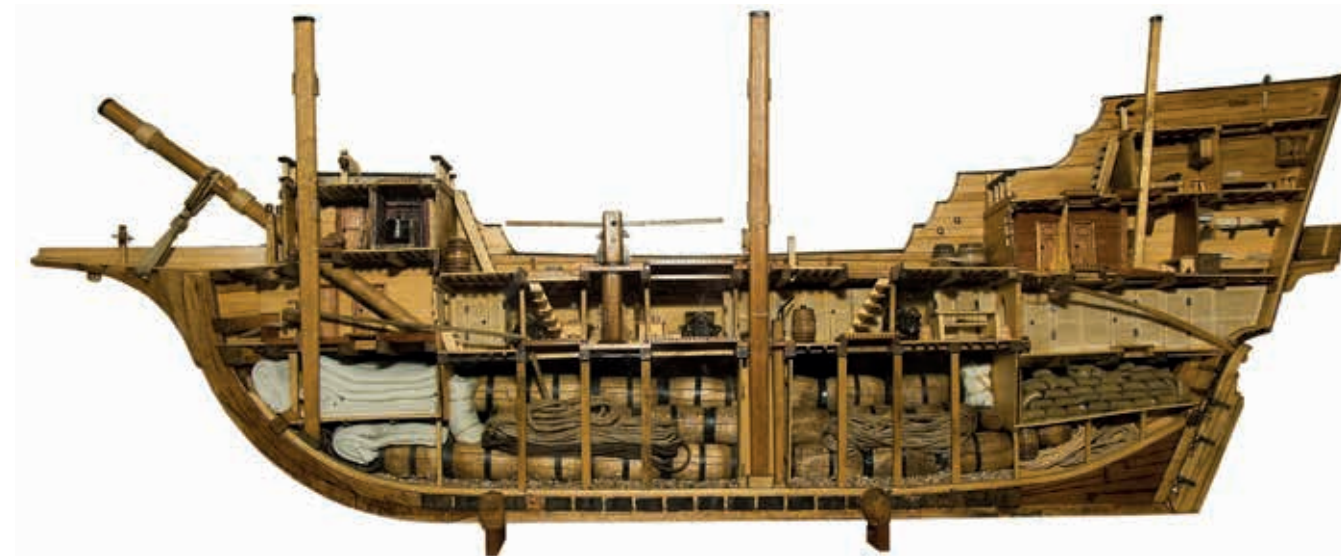
Модель, демонстрирующая устройство корпуса галеона начала XVII века
