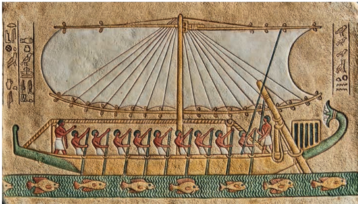
Египетское судно XVI века до н.э. Над головами гребцов виден толстый канат, придававший корпусу продольную прочность
