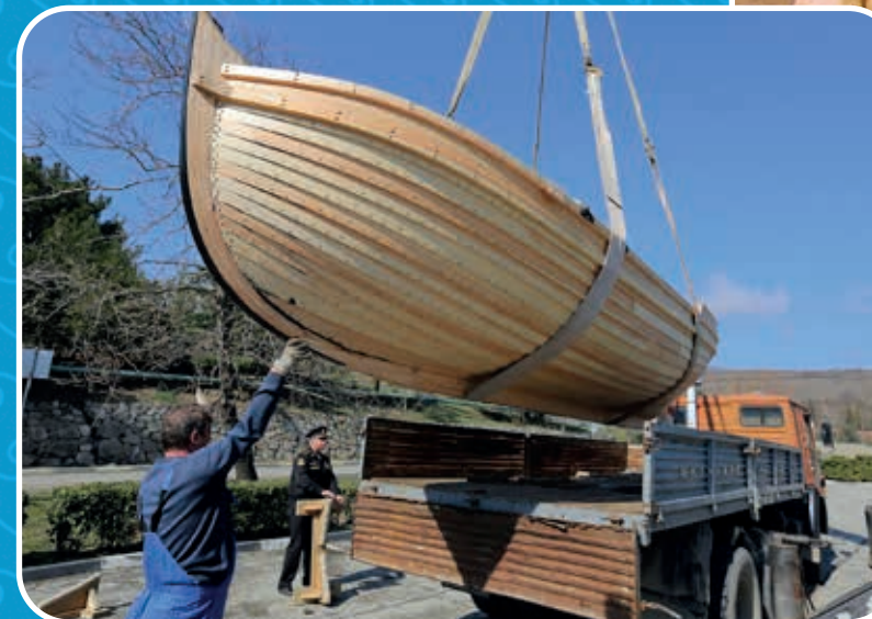
По размерам и конструкции «Дедушка русского флота» очень близок к шлюпке ЯЛ-6
