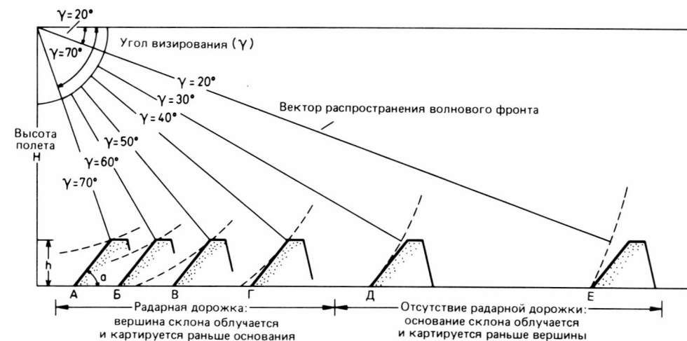
Рис. 111. Радарная дорожка как функция угла визирования (Manual of Remote Sensing, 1975).
