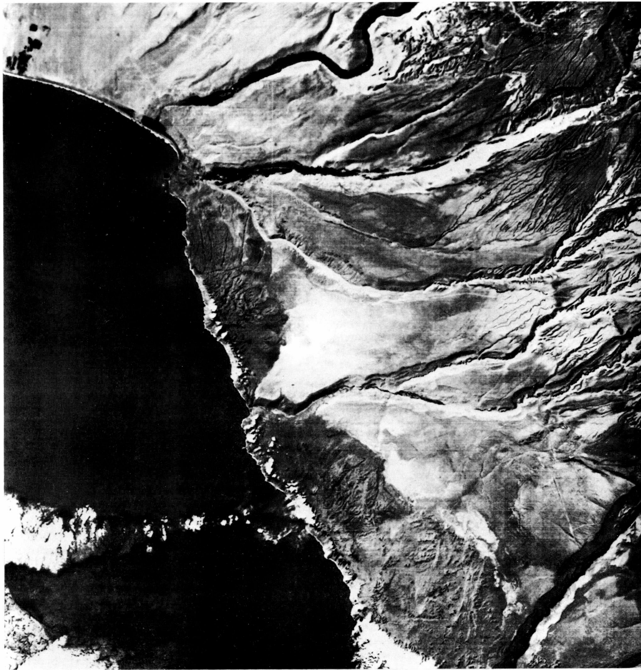
Рис. 94б. Фрагмент одного из первых снимков МОМС, полученный с космического корабля «Колумбия» 20 июня 1983 г. Изображенный на снимке участок располагается в районе Арики, Чили, в краевой части Анд. Разрешение на местности 20 \times 20 м. Изображение получено Р. Хайдном (ZGF, Мюнхен) на установке для обработки снимков. Линии сканирования на снимке располагаются вертикально, направление полета горизонтальное. Изображение не подвергалось геометрической и радиометрической коррекции. Масштаб около 1:1 000 000.
