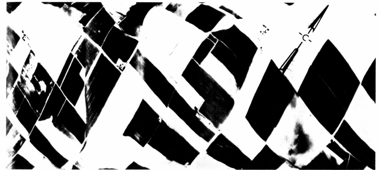
Рис. 74. Геометрическое искажение сканерных снимков.
