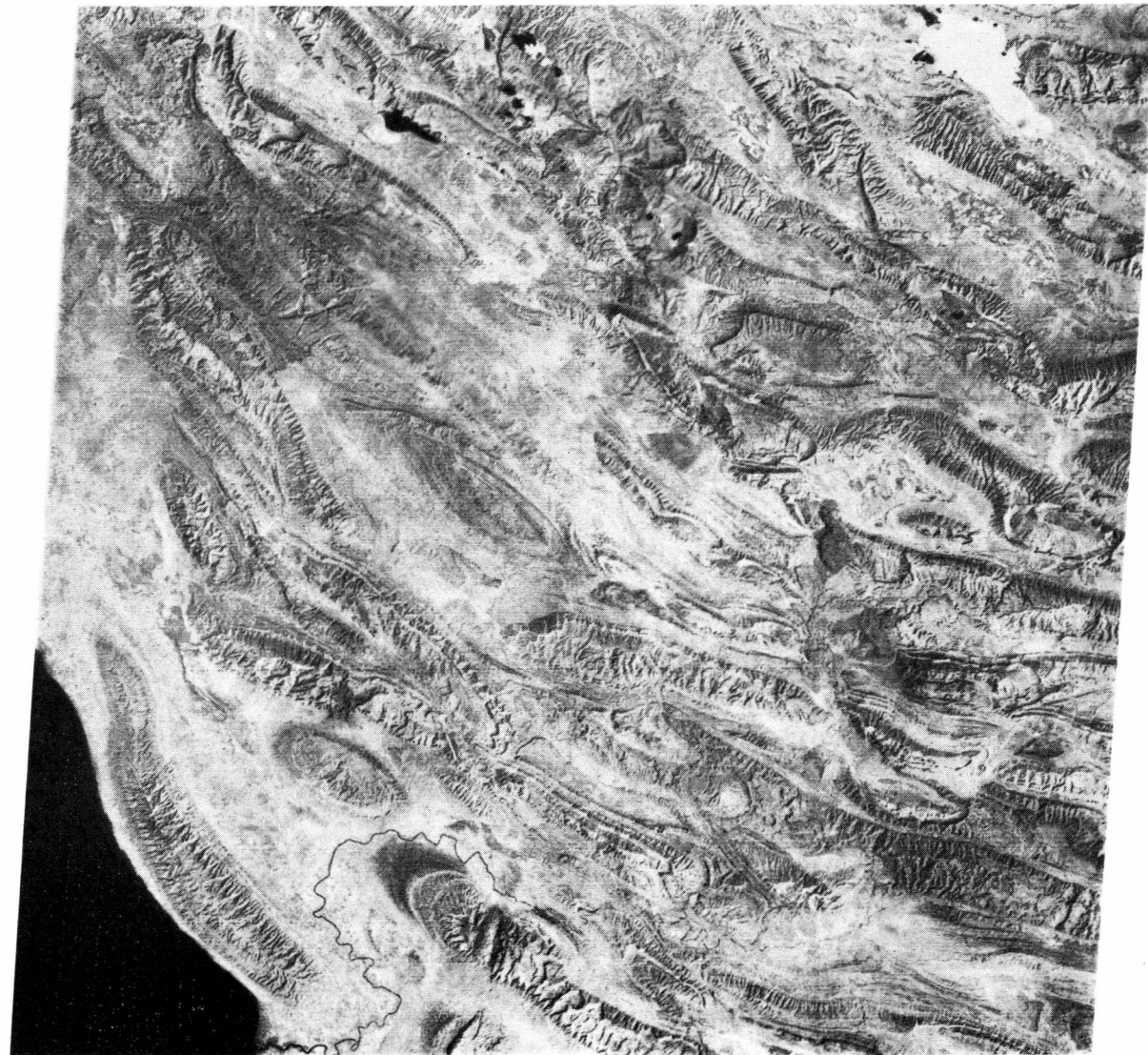
Рис. 174. Антиклинальные и синклиналичные структуры в юго-восточной части складчатой зоны Загроса, Иран. Масштаб около 1:1 000 000 (NASA, E-1438-06330).
