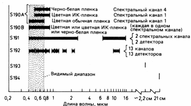
Рис. 60. Каналы съемки установленных сенсоров при проведении экспедиции на «Скайлэб» в рамках проекта ЭРЭП (Earth Resources Experiment Package; по публикации НАСА).
