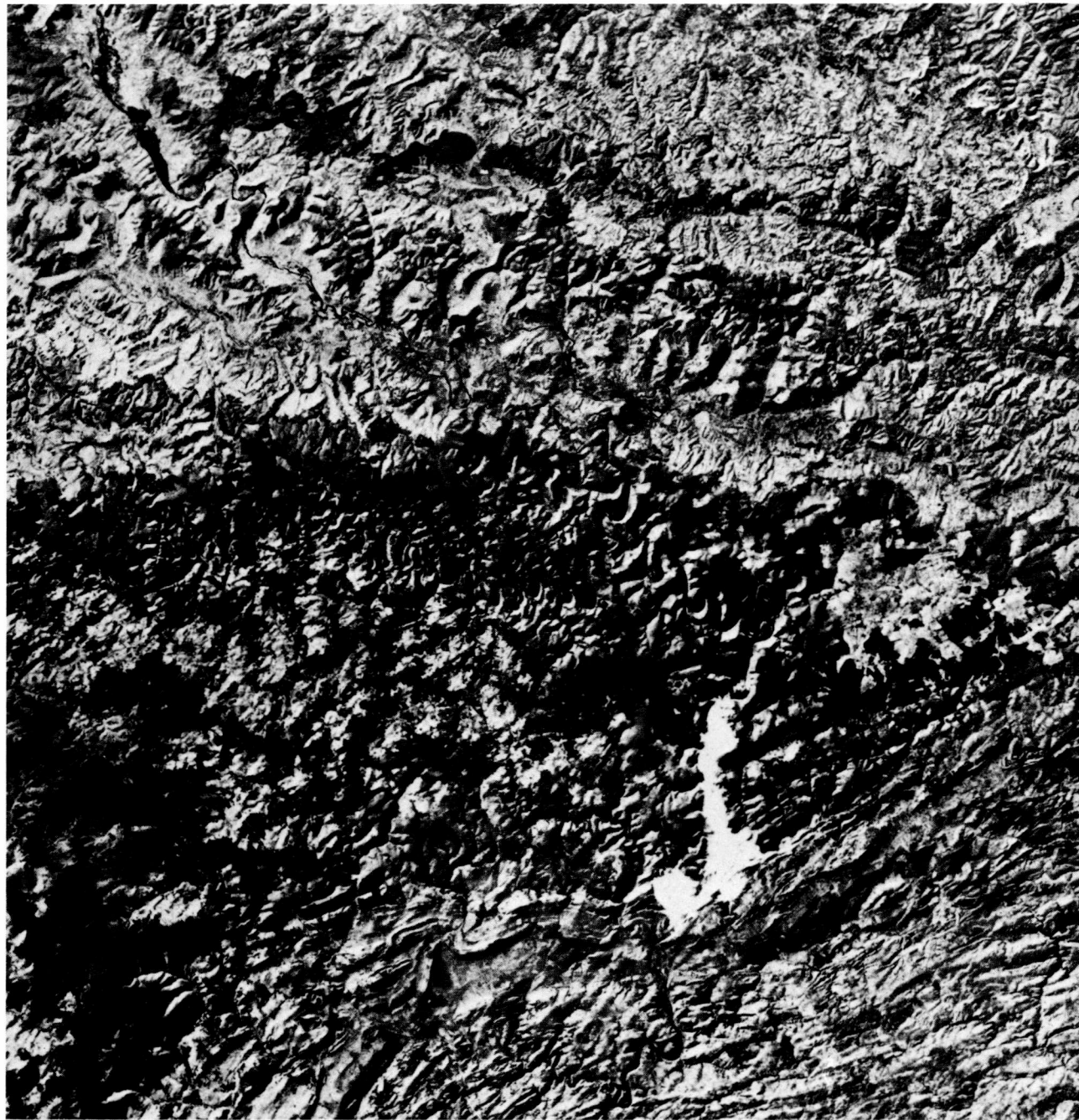
Рис. 91б. Фрагмент снимка ТМ района Арденн. Диапазон съемки 1,55–1,75 мкм (ТМ-канал 5). Масштаб снимка 1 : 500 000 (NASA/ESRIN TM 4 5, 198 25, 4, 23.1.83). В верхней части снимка распознаются специфические складчатые среднедевонские слоистые толщи Динантского синклинория. В центре справа (запад) узкая, в основном темная, полоса, соответствующая Арденнскому синклинорию, сложенному разновозрастными слоистыми толщами кембрия и нижнего девона. На юге они дискордантно перекрываются сериями мезозойских осадков (лейас–мел), простирающихся в Парижский бассейн. Пояснения см. в тексте.
