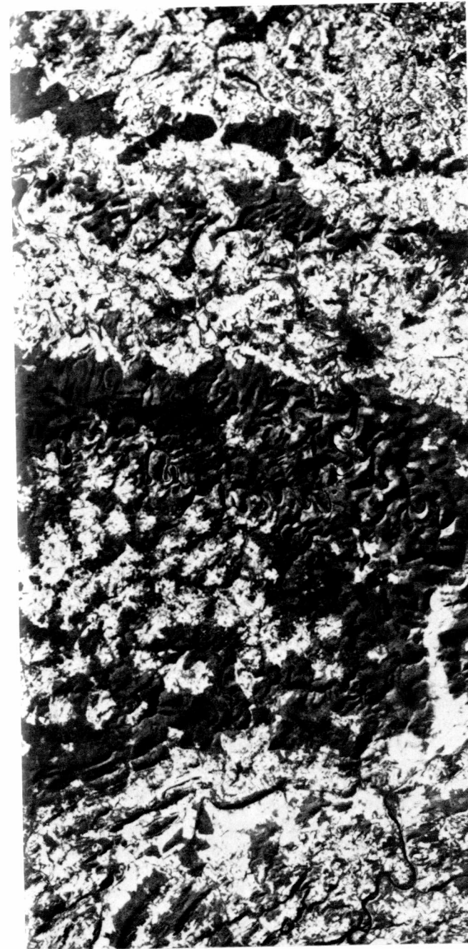
Рис. 92. Фрагмент изображенного на рис. 91а района Арденн. а – спектральный диапазон 0,76–0,90 мкм, ТМ-канал 4; б – 2,08–2,35 мкм, ТМ-канал 7. Обратите внимание на воспроизведение одинаковых участков местности, соответственно одинаковых ландшафтов и объектов на изображения канала 3. Масштаб 1 : 500 000.
