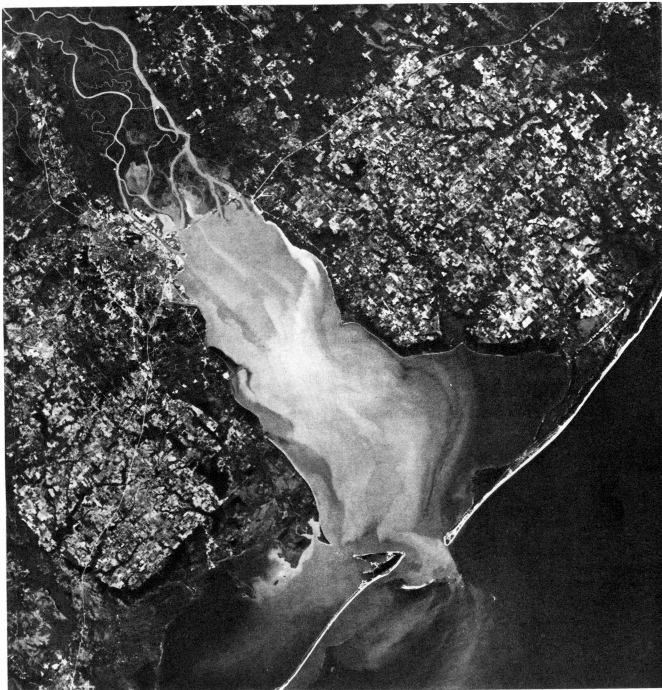
Рис. 146. Перенос осадков речными и прибрежными водами в районе залива Мобил, шт. Алабама, на снимке камерой ETC. Масштаб 1 : 500 000, оригинальный цветной снимок (NASA SL 4-92-300).
