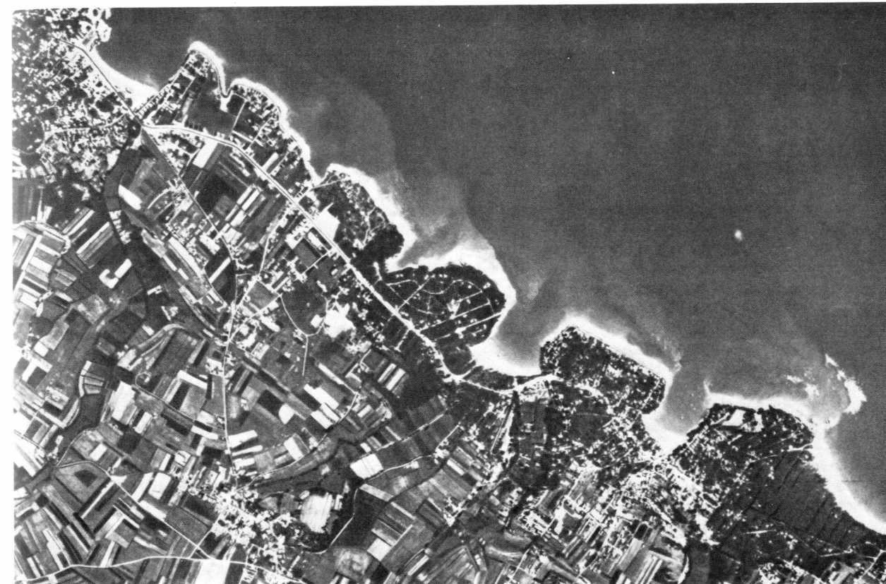
Рис. 43. Разница в серых тонах изображения показывает разную глубину вод и структуру поверхности осадков в прибрежной зоне. Распределение осадков происходит в соответствии с направлением переносящих их течений параллельно береговой линии. (Аэрофотоснимок I. G. N.)
