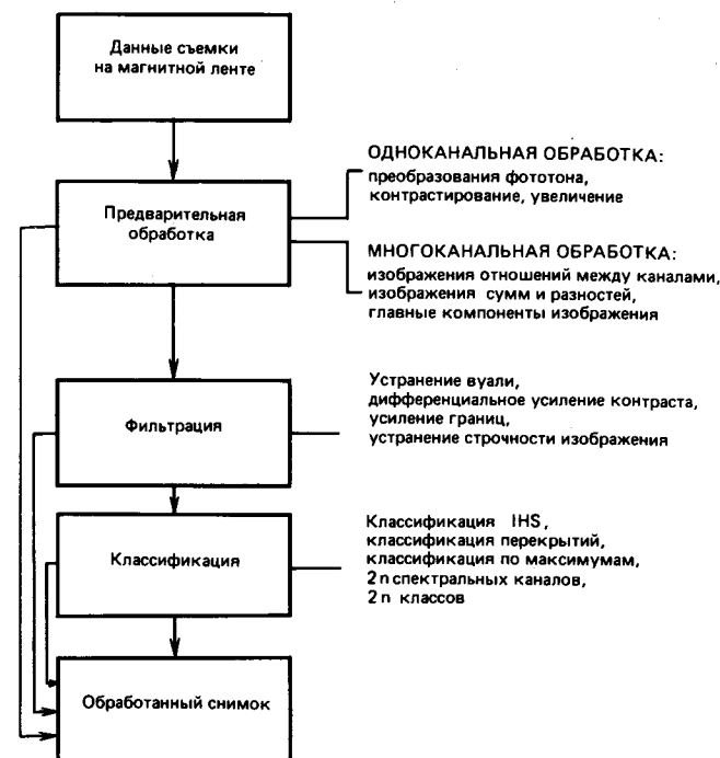
Рис. 121б. Программы и пути обработки, применяемые в системе ГЕОМАПС.
