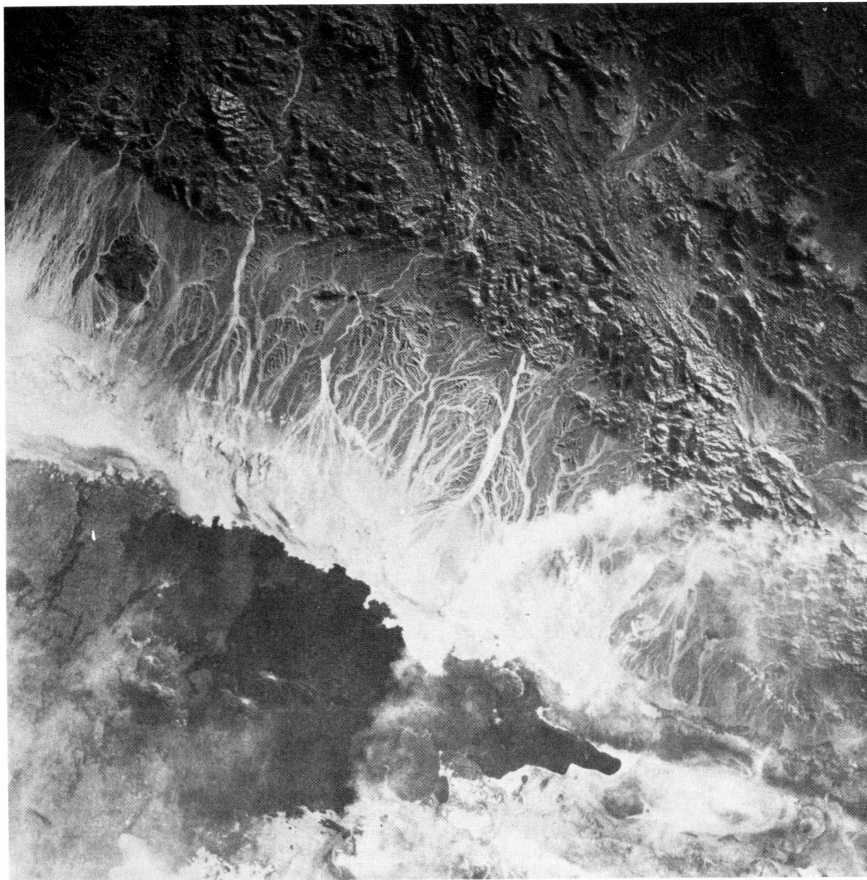
Рис. 140. Снимок камерой ETC (S 190B), Эфиопия. Увеличено до масштаба 1:500 000. Оригинал в условных цветах. Внизу – базальтовые вулканиты вдоль центрального грабена Данакиль. (NASA SL 3-RL-87-367).
