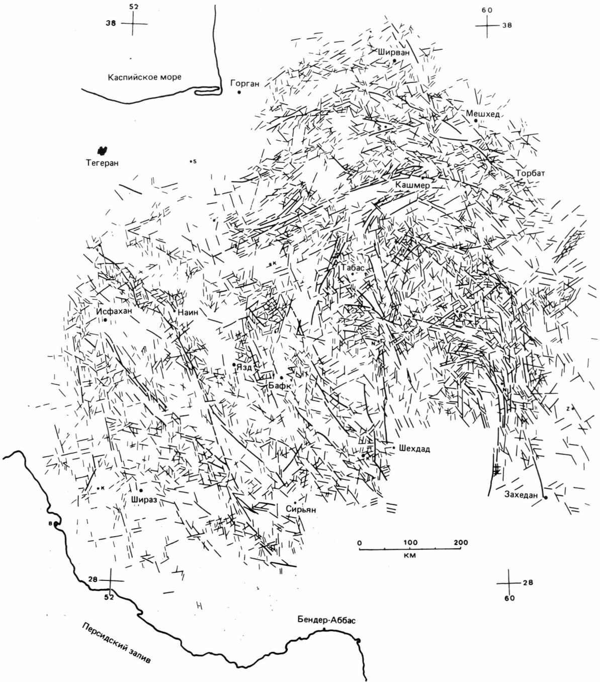
Рис. 170. Карта разрывных нарушений, зон нарушений и систем нарушений, откартированных по фотосхеме «Лэндсат» рис. 169. Карта составлена в масштабе 1:2 000 000 (по [163]).
