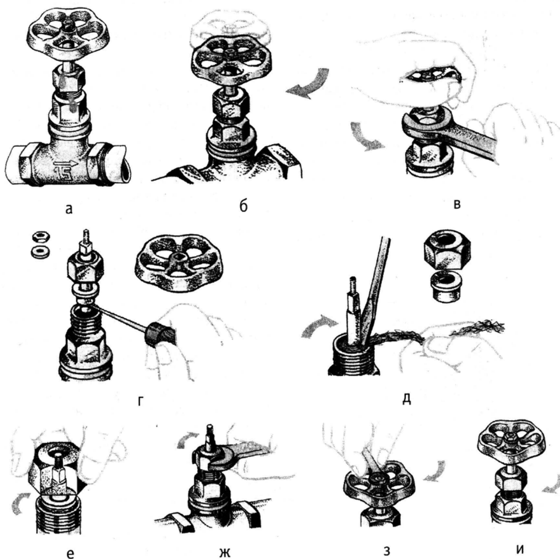
Рис. 1–3. Стадии донабивки или замены сальника при вентиле с накидной гайкой:
