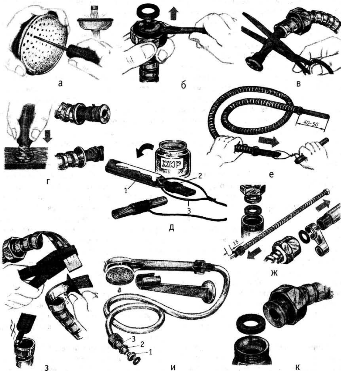
Рис. 1–2–18. Ремонт душевой сетки и гибкого шланга:
