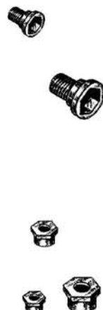
Рис. 1-1-10. Способы использования штока с частично изношенной резьбой
