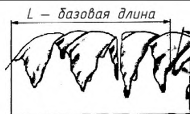
Средняя линия нужна для отсчета параметров шероховатости
