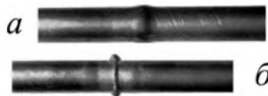
Рис. 4.16. Стыковая сварка стержней: а — сопротивлением; б — оплавлением
