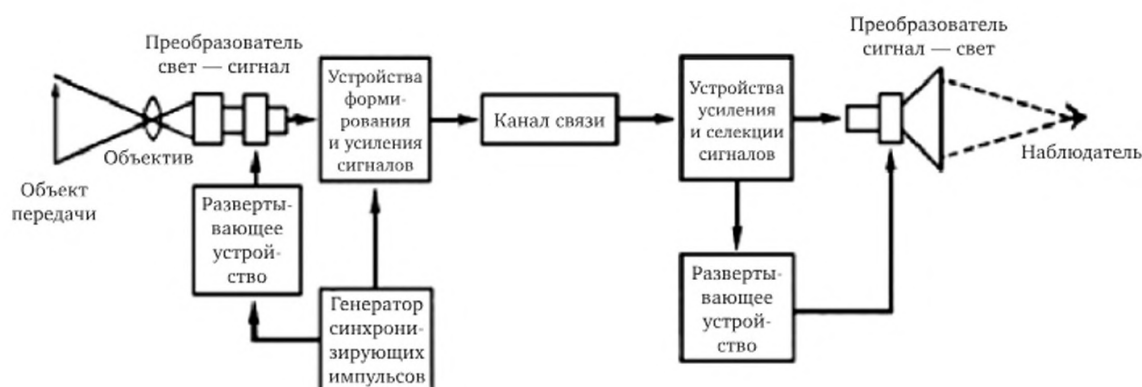
Рис. 9.4. Структурная схема системы телевизионного вещания
