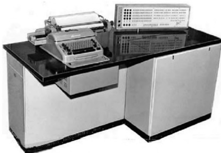
Рис. 1.27. ЭВМ «МИР-1» для инженерных расчетов, прототип современных персональных компьютеров (СССР)
