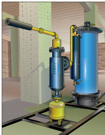
Рис. 54. Заводская установка и схема устройства воздушно-водяного генератора
