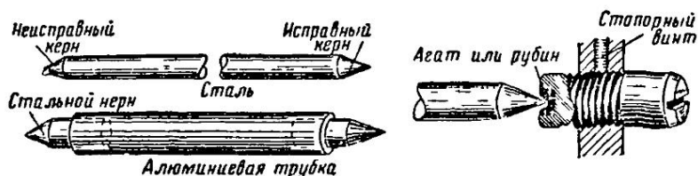
Фиг. 324. Конструкция осей и подпятника электроизмерительного прибора
