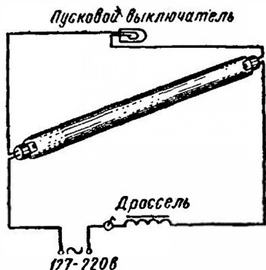
Фиг. 68. Схема включения люминесцентной лампы
