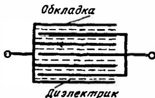
Фиг. 14. Схема устройства конденсатора постоянной емкости
