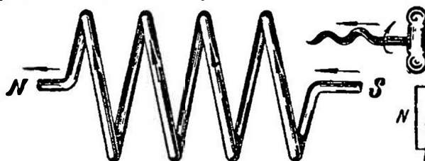
Фиг. 86. Определение полюсов соленоида
