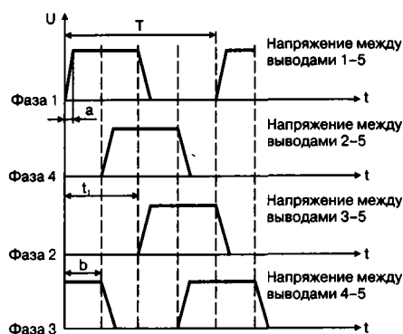
Рис. 42.3. Последовательность коммутации обмоток фаз
