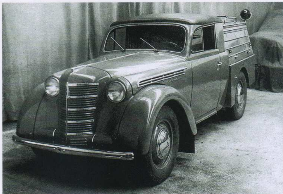
Первый изготовленный образец аэродромного пускового агрегата
