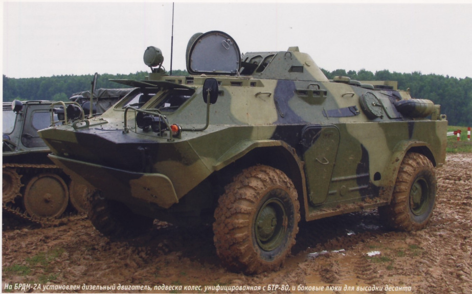
На БРДМ-2А установлен дизельный двигатель, подвеска колес, унифицированная с БТР-80, и боковые люки для высадки десанта
