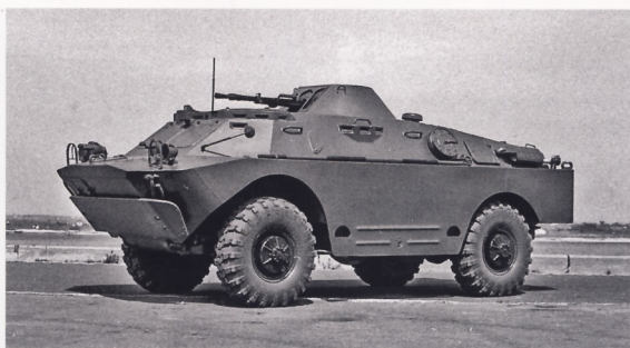
БРДМ-2 с башенной установкой со спаренной установкой пулеметов крупнокалиберного танкового пулемета КПВТ (калибр 14,5 мм) и пулемета ПКТ (7,62 мм)
