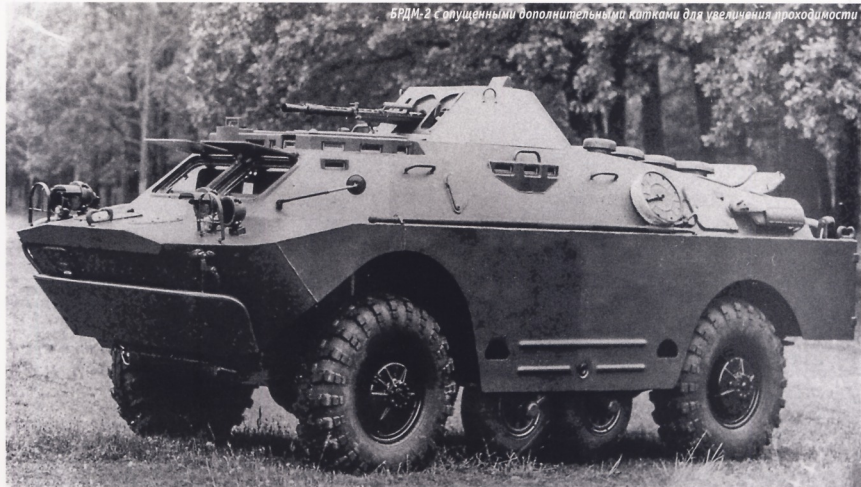
БРДМ-2 с опущенными дополнительными катками для увеличения проходимости
