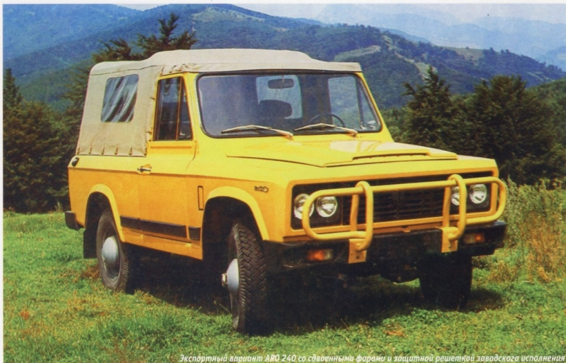
Экспортный вариант АРО 240 со сдвоенными фарами и защитной решеткой заводского исполнения
