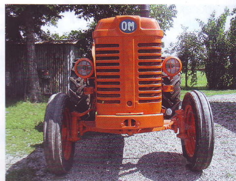
Ширину передней колеи фермер мог изменить на пять ступеней. В зависимости от диаметра задних колес в две ступени также регулировался дорожный просвет.
