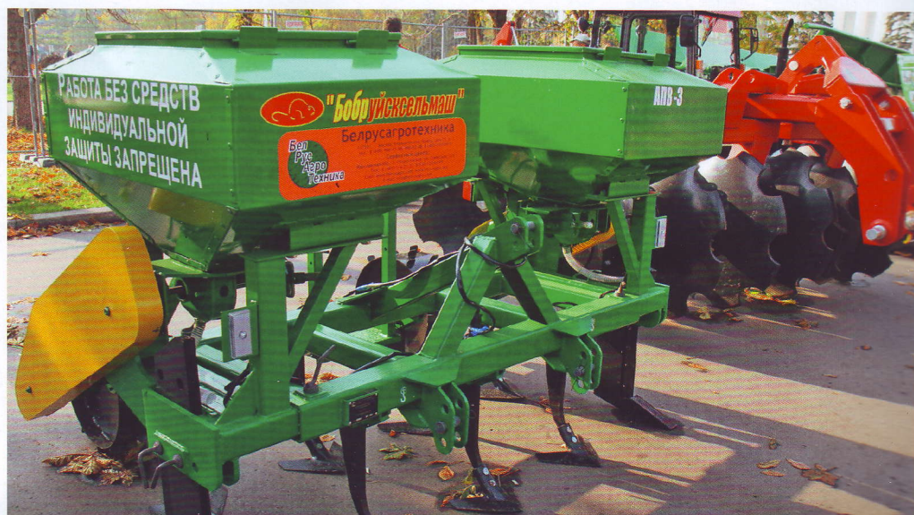
Агрегат почвообрабатывающий с внесением удобрений для садов и виноградников. Выставка сельскохозяйственной техники, ВДНХ. 2014 г.
