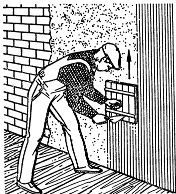
Рис. 66. Намазывание раствора соколом:
