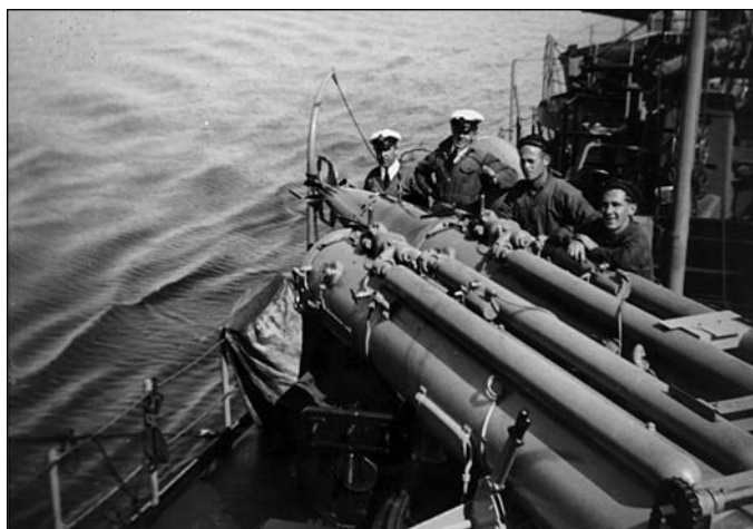
533-мм торпедный аппарат миноносца «Слейпнер»
