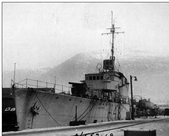
«Слейпнер» в резерве, 1944 г. Хорошо видны антенны РЛС типа 271 (на мостике) и 291 (на мачте)
