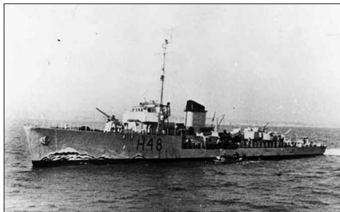
«Слейпнер» после модернизации 1942 г. с двумя 102-мм орудиями Mk.V и радаром типа 286PU
