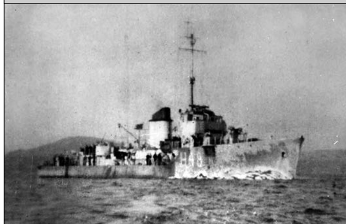
«Слейпнер» после модернизации 1942 г. с двумя 102-мм орудиями Mk.V и радаром типа 286PU
