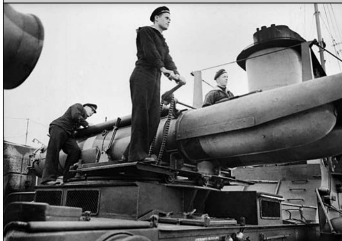
533-мм торпедный аппарат миноносца «Слейпнер»
