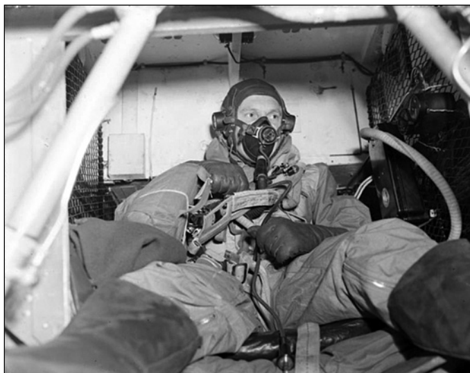
«Пассажирский салон» «Москито». Пассажир размещался в бомбовом отсеке. Поскольку последний был негерметичным, обязательным атрибутом перелета являлась кислородная маска.
