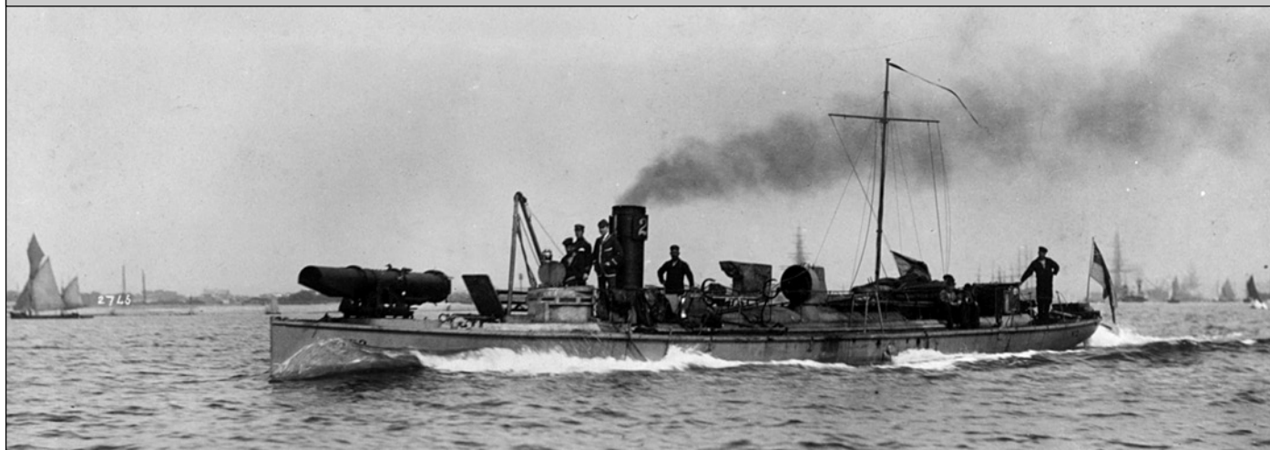
Миноносцы 1-го класса ТВ-12 (вверху) и ТВ-3 (внизу). Хорошо видно, что установка торпедного аппарата привела к появлению заметного дифферента на нос
