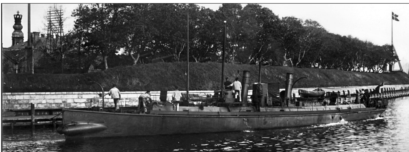
Датский миноносец «Delfinen» после замены локомотивного котла двумя водотрубными
