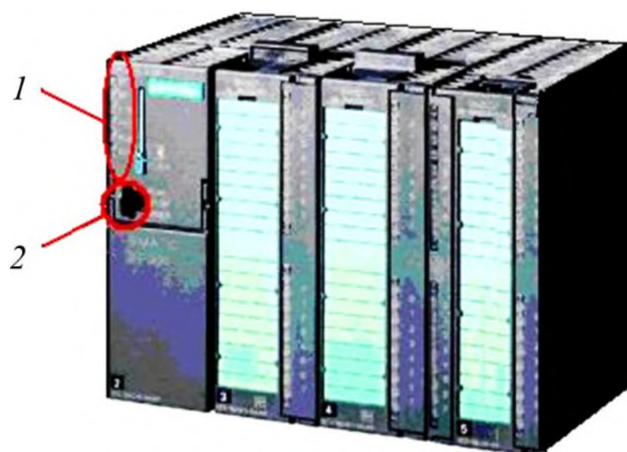
Рис. 2.1. Siemens Simatic S7-300: 1 – индикаторы состояния; 2 – переключатель
