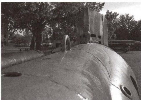
Устройства для буксировки на носу «Зеехунда» и кормовой швартовочный рым. На нижнем снимке у кормовой оконечности рубки виден также кормовой рым, предназначенный для подъема лодки
