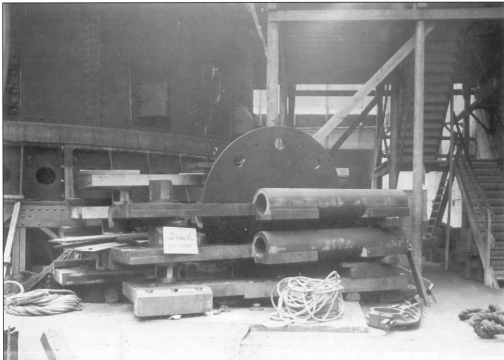
Детали 356-мм трехорудийной артиллерийской установки у собранной башенной конструкции в мастерской Металлического завода
