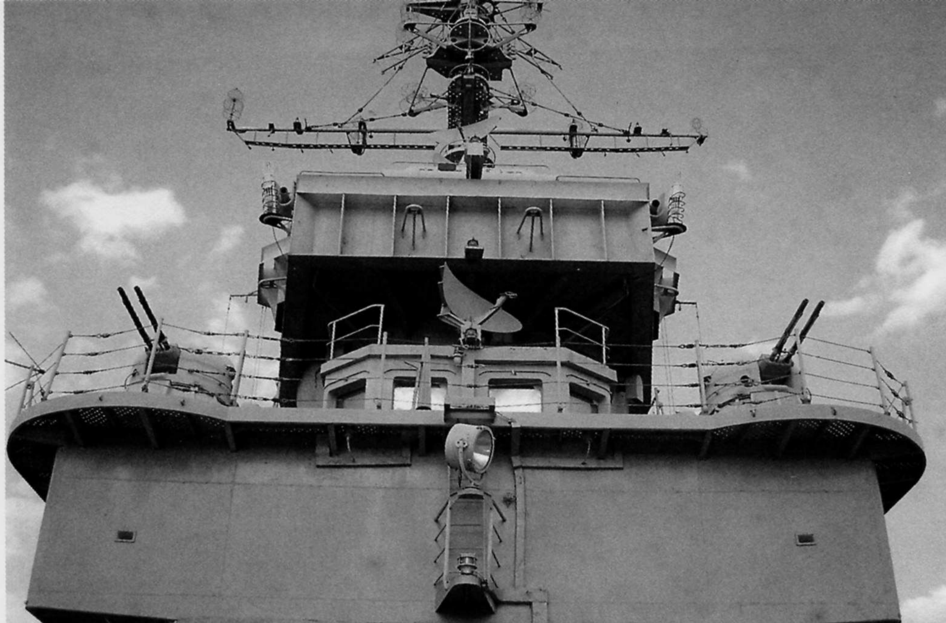
Верхняя часть носовой надстройки крейсера «Михаил Кутузов» с 30-мм автоматами АК-230 носовой группы
