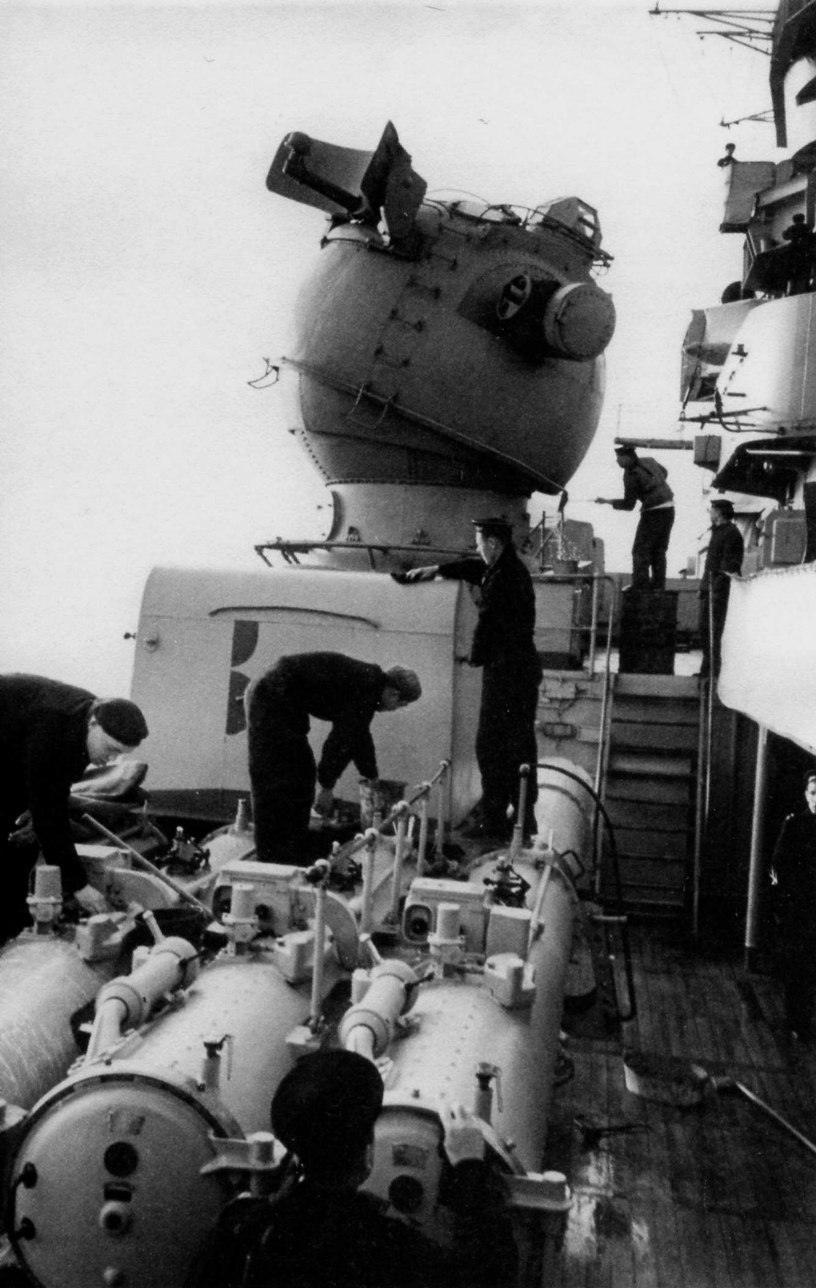
Торпедное оружие на крейсерах пр. 68-бис выглядело явным анахронизмом. На снимке: обслуживание торпедного аппарата на «Адмирале Ушакове», 1954—1955 гг.
