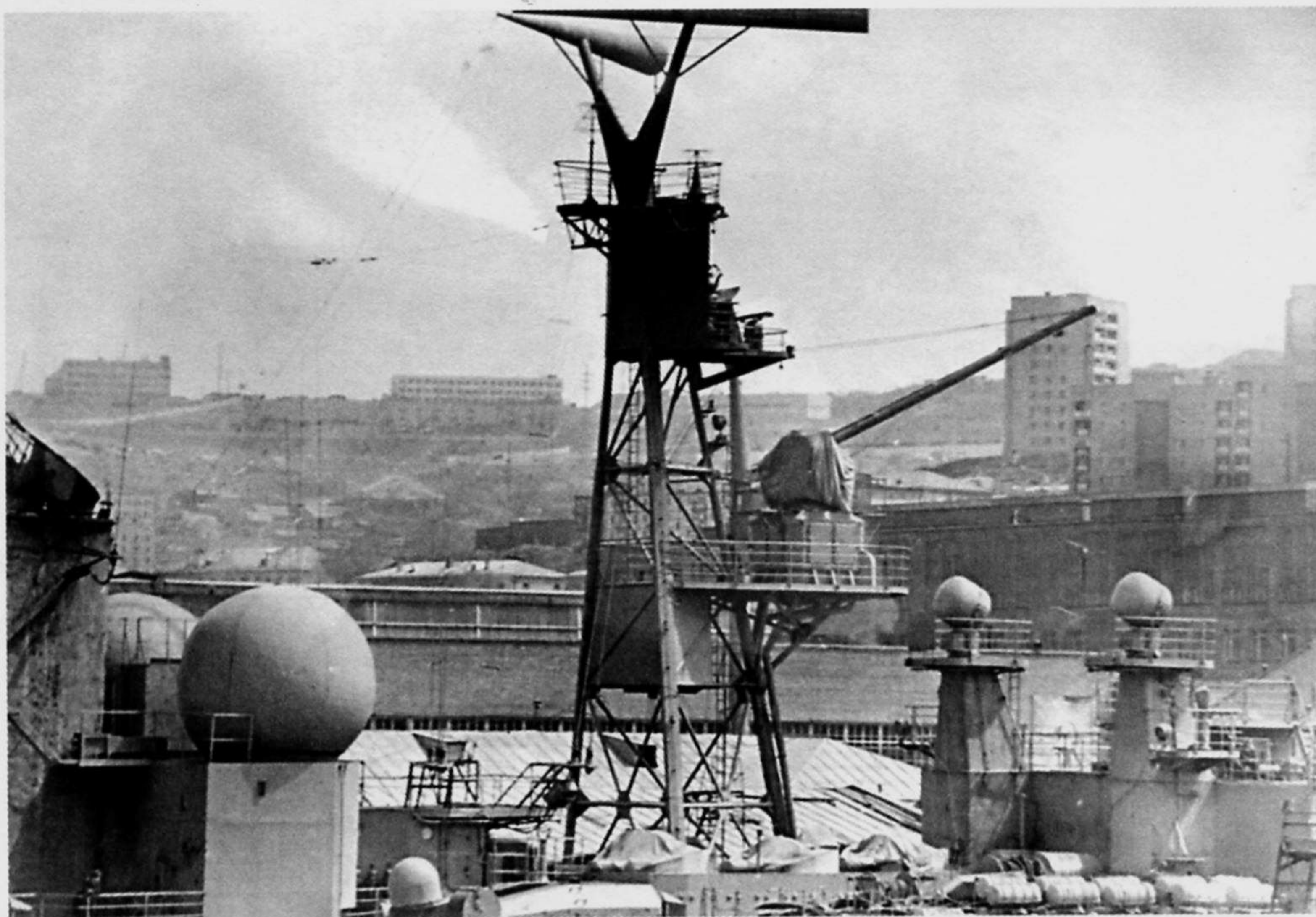
Треногая 3-я мачта крейсера управления «Адмирал Сенявин» с коническими антеннами радио- передатчика «Вяз». Слева на снимке видны сферические АП станции «Кристалл-К», справа — два поста артиллерийских РЛС МР-104 «Рысь»
