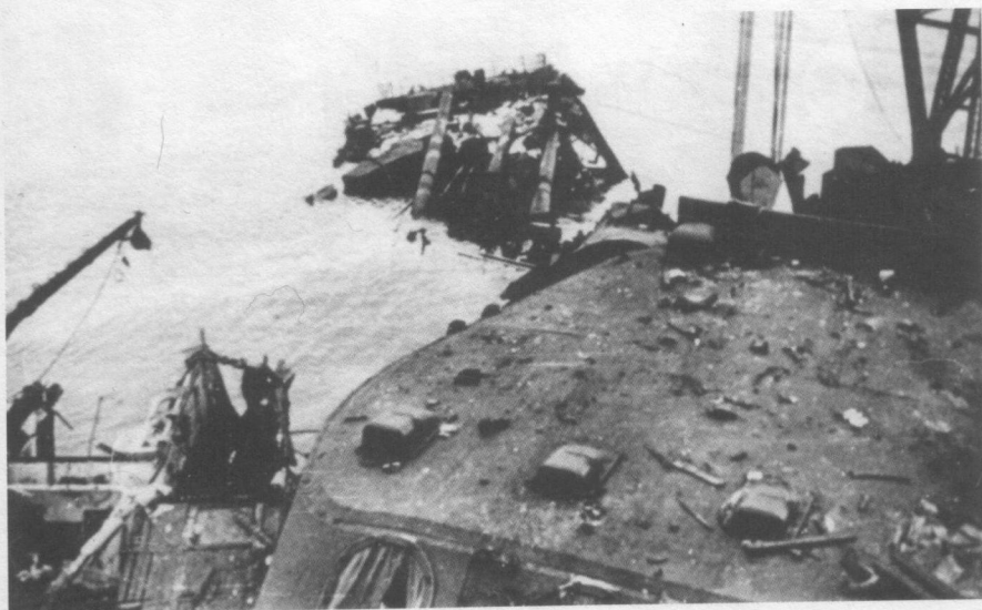
Повреждения «Марата» после взрыва: вид на разрушенную носовую часть (вверху и в центре) и вид с носа на 2-ю башню ГК (внизу)
