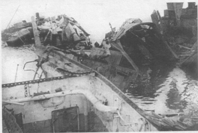
Повреждения «Марата» после взрыва: вид на разрушенную носовую часть (вверху и в центре) и вид с носа на 2-ю башню ГК (внизу)
