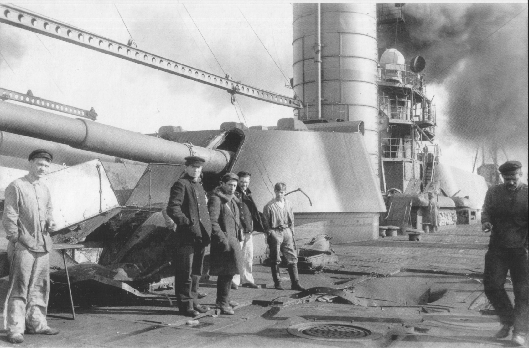
Линкор «Петропавловск» после подавления Кронштадтского мятежа. Пробойна в палубе — результат попадания 10-дюймового снаряда с форта «Красная горка», 1921 г.
