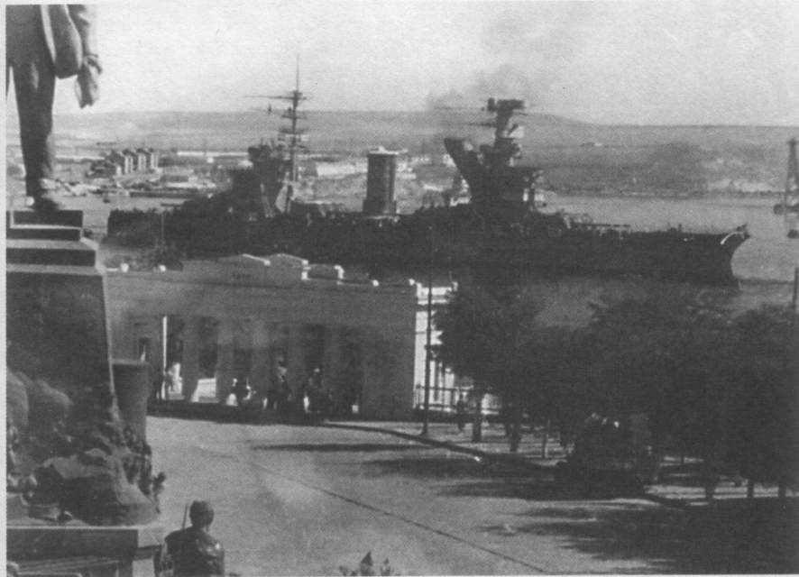
«Парижская коммуна» входит в Южную бухту Севастополя. Модернизация линкора еще не завершена: на мачтах и надстройках отсутствуют зенитная артиллерия и КДП
