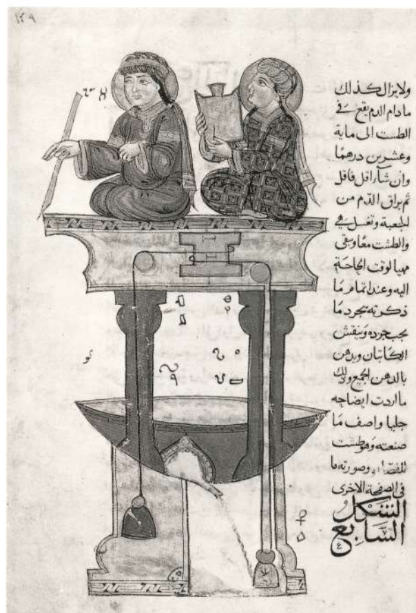
2. Рисунок в рукописи «Automata» о технических изобретениях представляет работу с замысловатым прибором для измерения объема крови, которая собирается в емкость, установленную внизу. XIII век.
