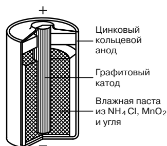
Рис. 2.62. Сухой элемент типа «стаканчик»
