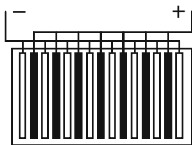
Рис. 2.65. Схема соединения пластин кислотного аккумулятора
