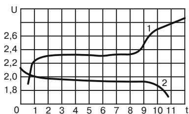
Рис. 2.64. График изменения напряжения кислотного аккумулятора
