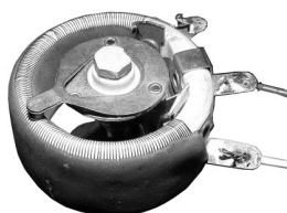
Рис. 1.9. Мощный потенциометр
