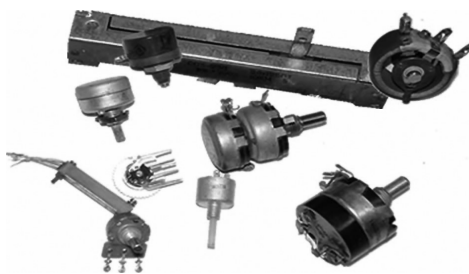
Рис. 1.12. Набор переменных сопротивлений (потенциометров)
