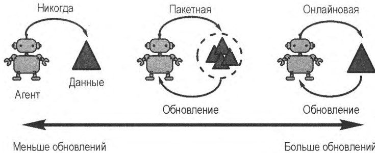
Рис. 10.9. Частота обновления производственной политики влияет на стратегию развертывания. Любая стратегия развертывания находится в континууме между отсутствием обновления (развертывание вручную) и полным онлайн-обновлением
