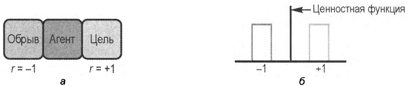
Рис. 4.5. Изображение мультимодальных наград для состояния: а — простая сетка с обрывом с одной стороны и полезной целью — с другой; б — распределение вознаграждения имеет два противоположных вознаграждения, а среднее значение, которое совпадает с функцией ценности для этого состояния, равно нулю
