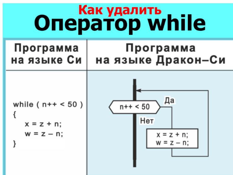
Рис. 158. Оператор while можно удалить и заменить на управляющую графику языка ДРАКОН
