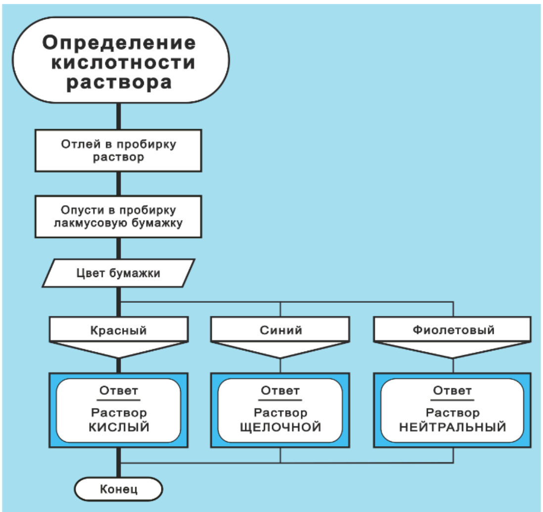
Рис. 148. Как определить кислотность раствора
