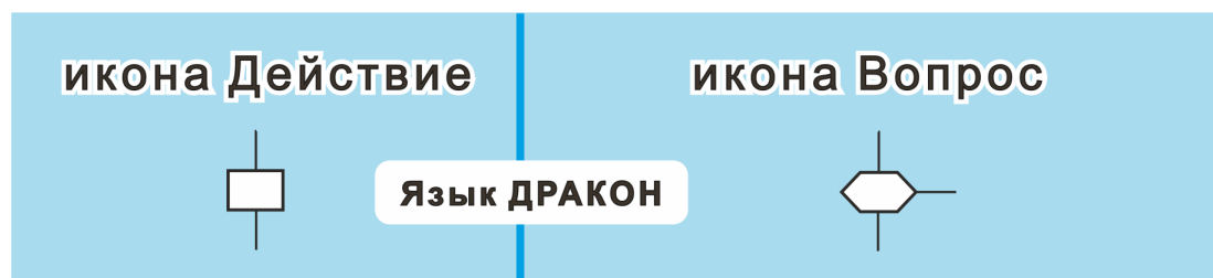
Рис. 188. Язык ДРАКОН предлагает однозначный (единственный) вариант присоединения отростков к иконам. Икона Действие имеет два отростка: входной (сверху) и выходной (снизу).
