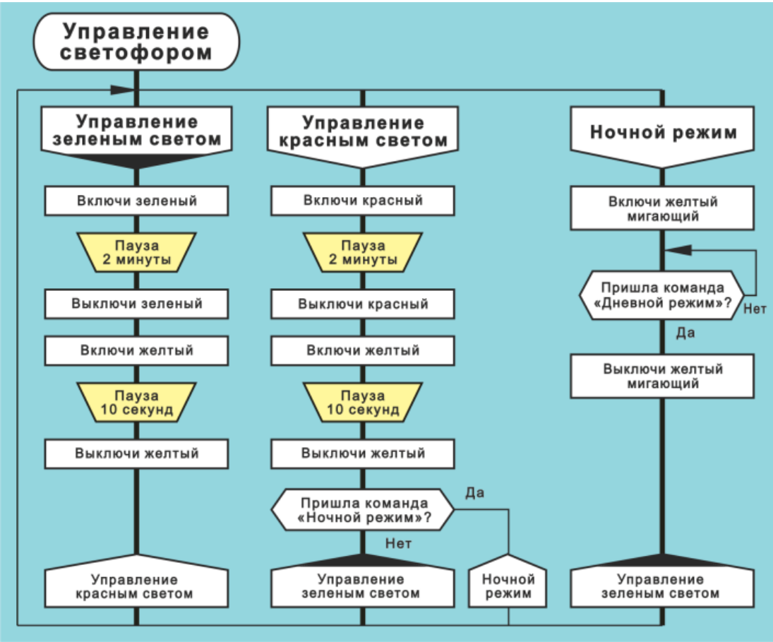
Рис. 113. Алгоритм «Управление светофором»
