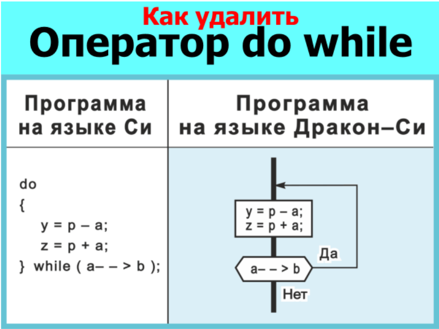
Рис. 160. Оператор do while можно заменить на управляющую графику
