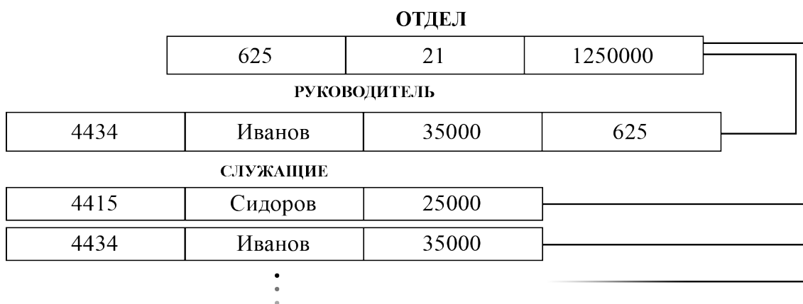
Рис. 13: Экземпляр типа дерева (уже с данными), изображенного на рис. 12
