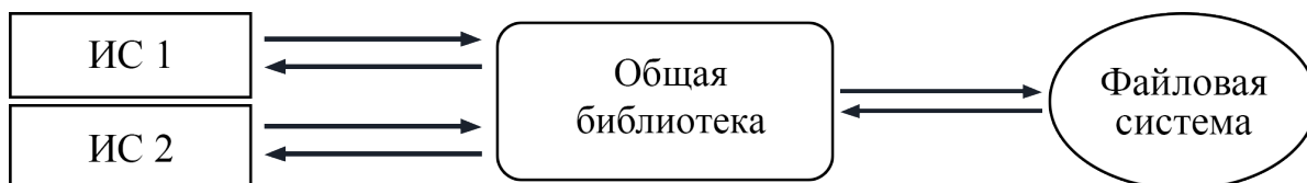
Рис. 7: Функции работы с ФС вынесены в общую библиотеку
