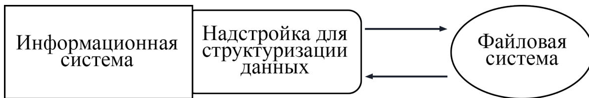
Рис. 6: Работа с ФС через дополнительную надстройку над ИС
