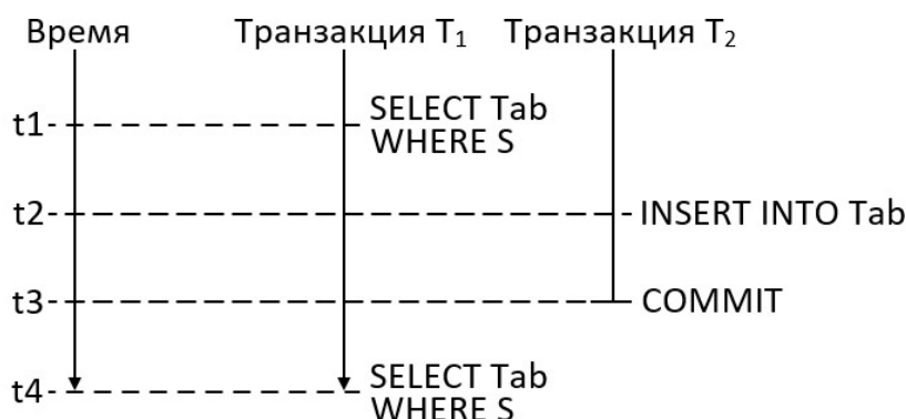
Рис. 96: Транзакция T_1 при повторном SELECT получает иной результат
