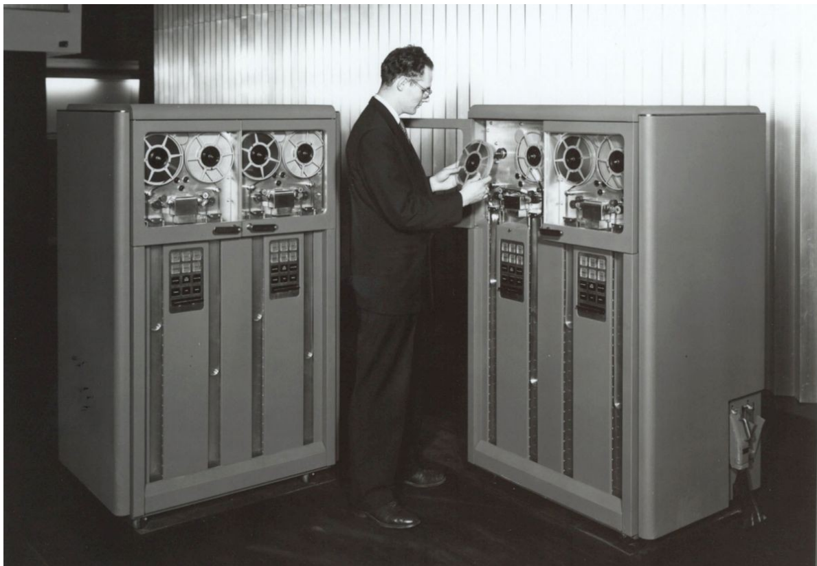
Рис. 2: IBM 726, первый аппарат записи данных на магнитную ленту, 1952г.
