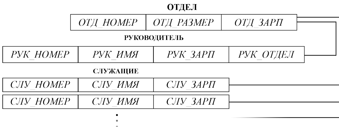
Рис. 12: Схема иерархической БД
