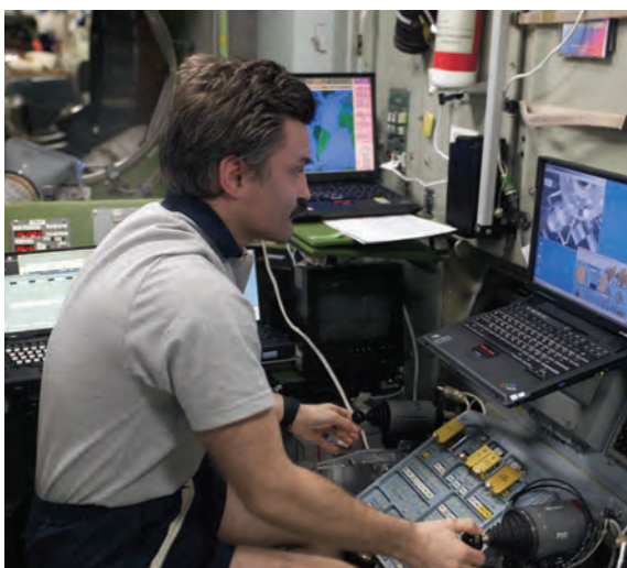
Система ТОРУ в модуле «Звезда» для обеспечения ручной стыковки кораблей «Прогресс» к МКС
