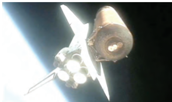
Разгон до орбитальной скорости на маршевых двигателях. Снимок автоматической камеры, установленной на отделившемся ускорителе
