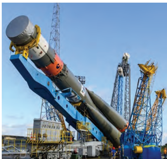
Установка ракеты-носителя «Союз-СТ-Б» с разгонным блоком «Фрегат-МТ» и четырьмя европейскими аппаратами ОЗв на стартовый стол космодрома Куру
