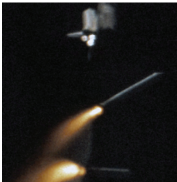
Отделение твердотопливных ускорителей, 126 секунд от момента запуска, высота около 45 км
