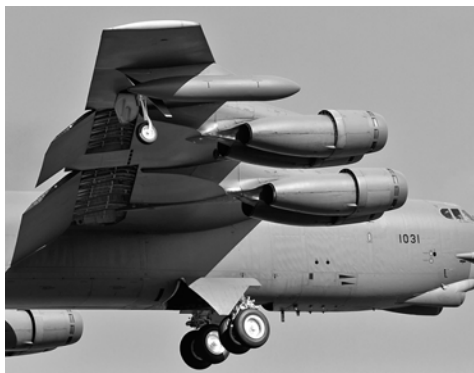
Восемь двигателей TF33-P-103 попарно размещены на восьми пилонах.
