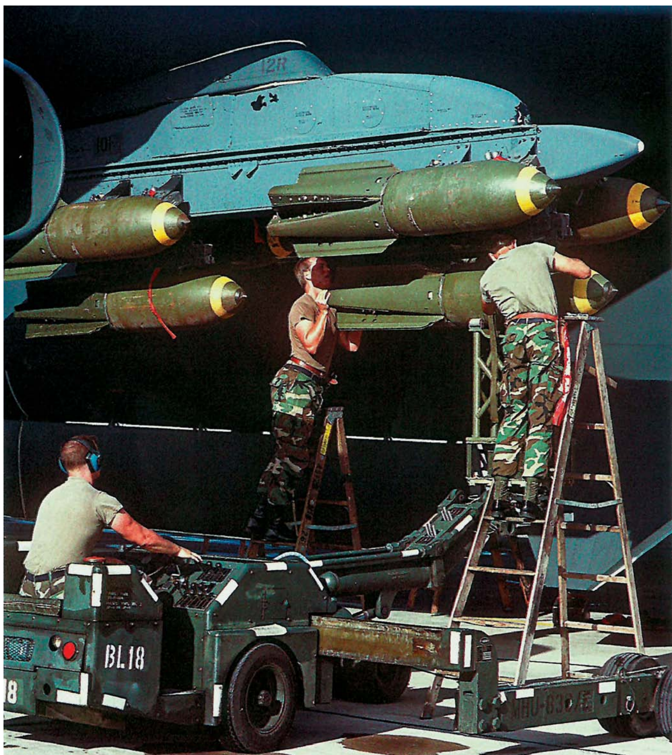
Операция Буря в пустыне. Подвеска бомб M117R с тормозными стабилизаторами
