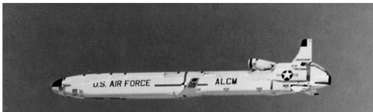
Крылатые ракеты — конкуренты. Вверху: ALCM (AGM-86) (коррекция по рельефу местности) — состоит на вооружении ВВС. Внизу: AGM 109 Томагавк — состоит на вооружении ВМФ.
