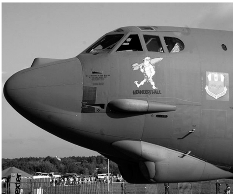
В носу — обтекатель антенны «стратегического» радара AN/ASQ-172. В обтекателе в виде слезинки — антенна для постановки помех AN/ALQ-172, под фюзеляжем — обтекатели оптической системы EVS.
