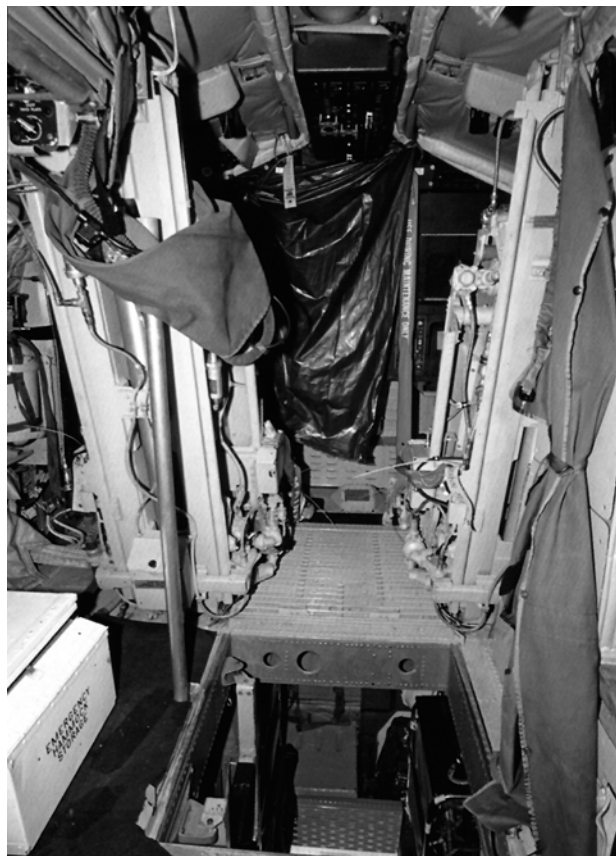
Верхняя палуба, вид в корму. Снизу — люк и лестница для спуска на нижнюю палубу. На заднем плане, за коричневым занавесом, — рабочее место офицера РЭБ и сиденье стрелка.
