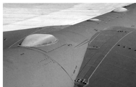
Антенны на спине фюзеляжа. Слева направо: связная AN/ARR-85, навигационная GPS и космическая связь AN/ASC-19. Обратите внимание на мощную накладку в месте стыка крыла и центроплана.
