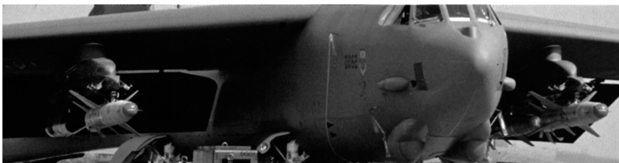
В-52Н с тремя ракетами AGM-142 Have Nap. На хвостовой части правого пилона подвешен контейнер AN/ASW-55, предназначенный для управления ракетами.
