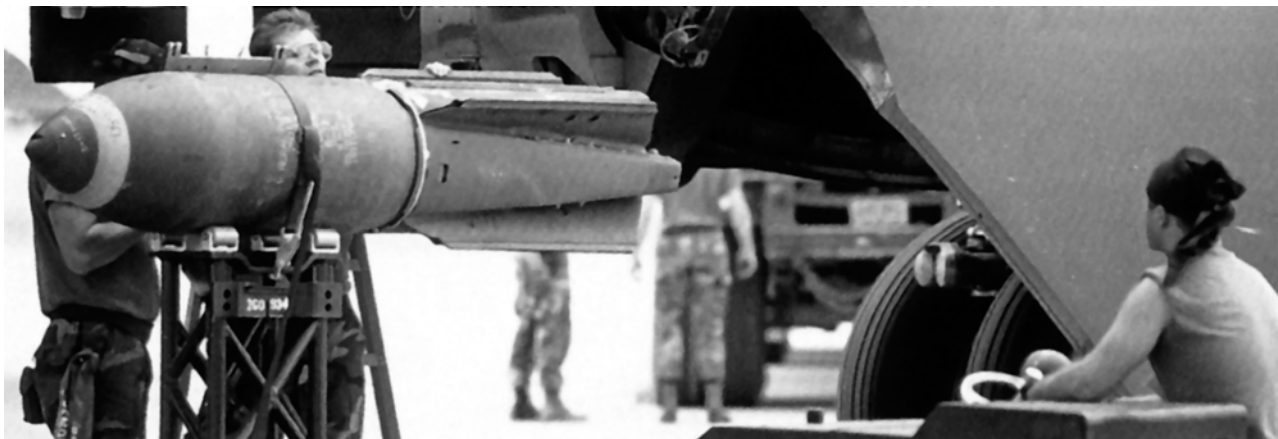
«Операция Буря» в пустыне. Вверху — подвеска бомбы M117R, внизу — бомбы M117 с коническими хвостами на внешней подвеске B-52.
