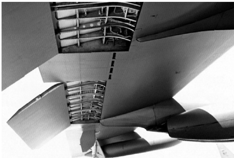
Четыре щели между нишами закрылков служат для выброса дипольных отражателей.
