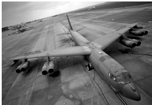
В носу — обтекатель «стратегического радара», далее — остекление кабины. На крыше видны остекленные аварийные люки пилотов. Далее — аварийные люки бортстрелка и оператора РЭБ. Далее — антенны радиоэлектронных средств и средств космической связи.
