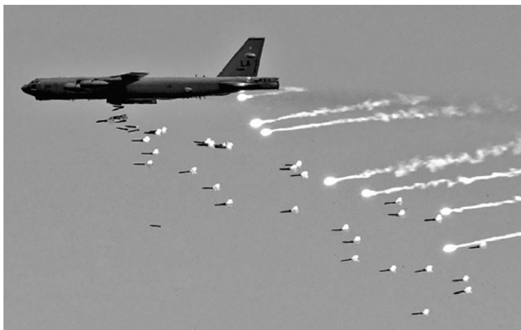
Операция «Буря в пустыне». В-52Н сбрасывает бомбы Mk 82 с наддувными тормозами и отстреливает ИК ловушки.
