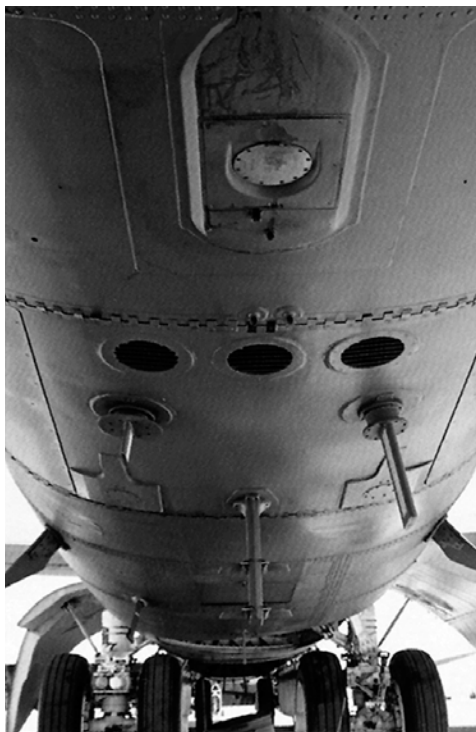
Низ хвостовой части фюзеляжа. Вид от стабилизатора в нос. Видны многочисленные антенны средств РЭБ. Три круглых отверстия служат для выхода воздуха системы охлаждения аппаратуры РЭБ.
