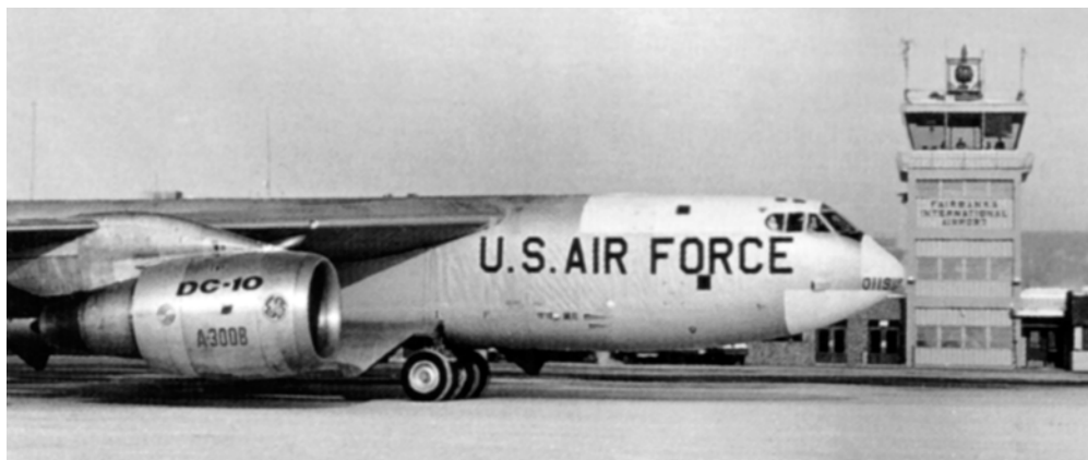
Летающая лаборатория NB-52E с двухконтурным двигателем CF6-50 во время климатических испытаний в Фэрбенксе. Двигатель был запущен при температуре -27,2^{\circ}\text{C} .
