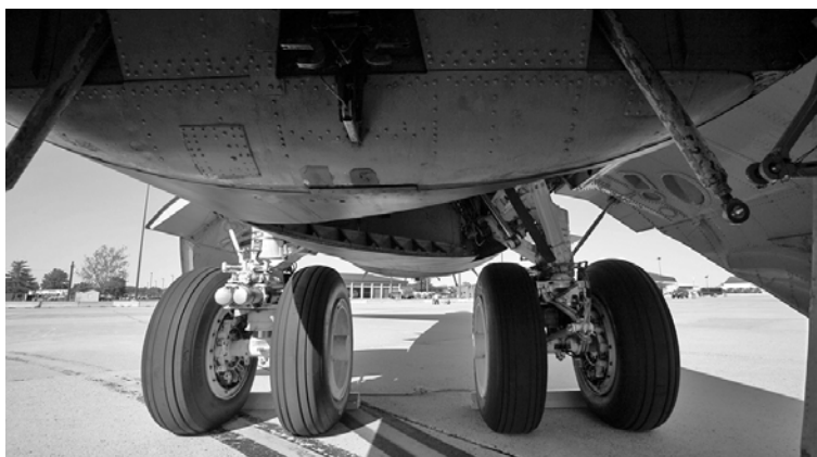
Задние стойки шасси. Вид из бомбового отсека в корму.
