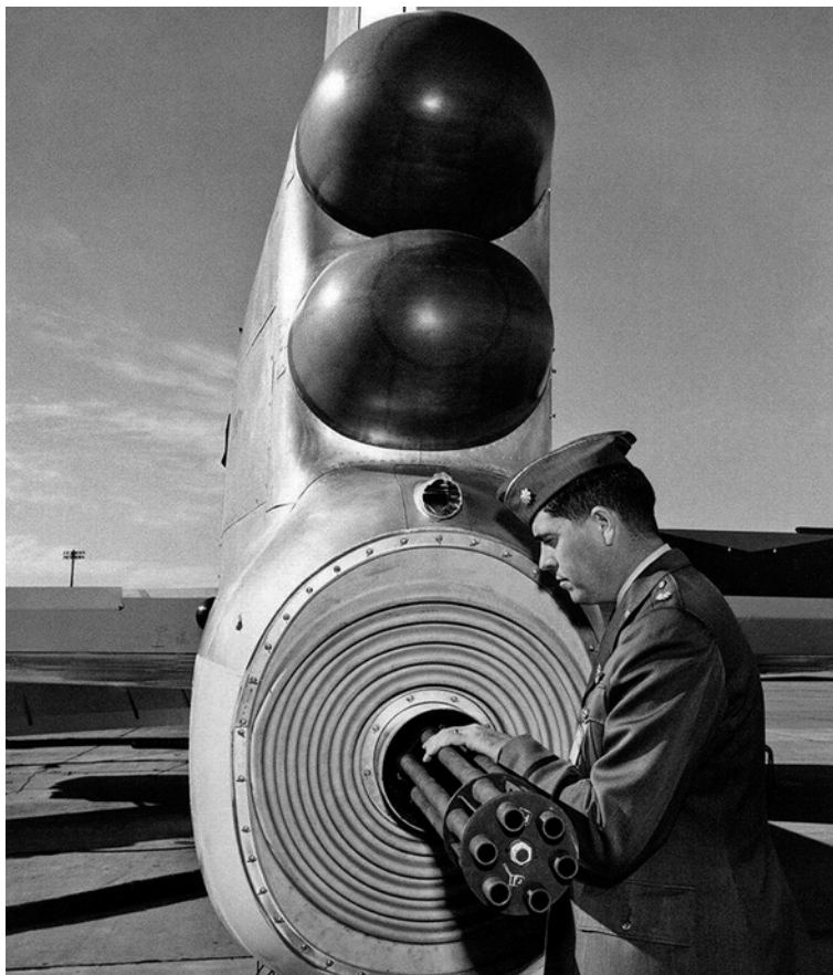
Шестиствольную пушку M61A1 кал. 20 мм сняли в 1991–1994 годах.
