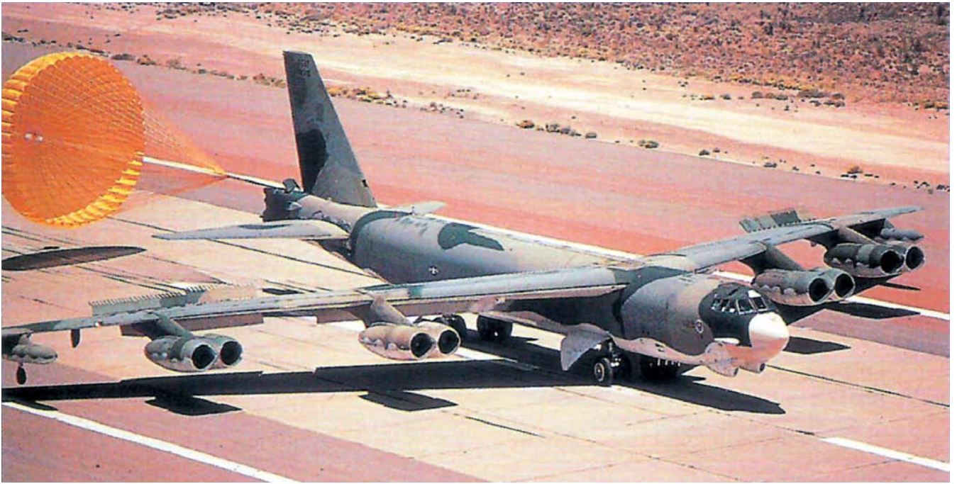
В-52G так же как В-52Н имели трехцветный камуфляж и белую окраску нижних поверхностей. Тормозной парашют хранился в контейнере за задней кромкой руля направления
