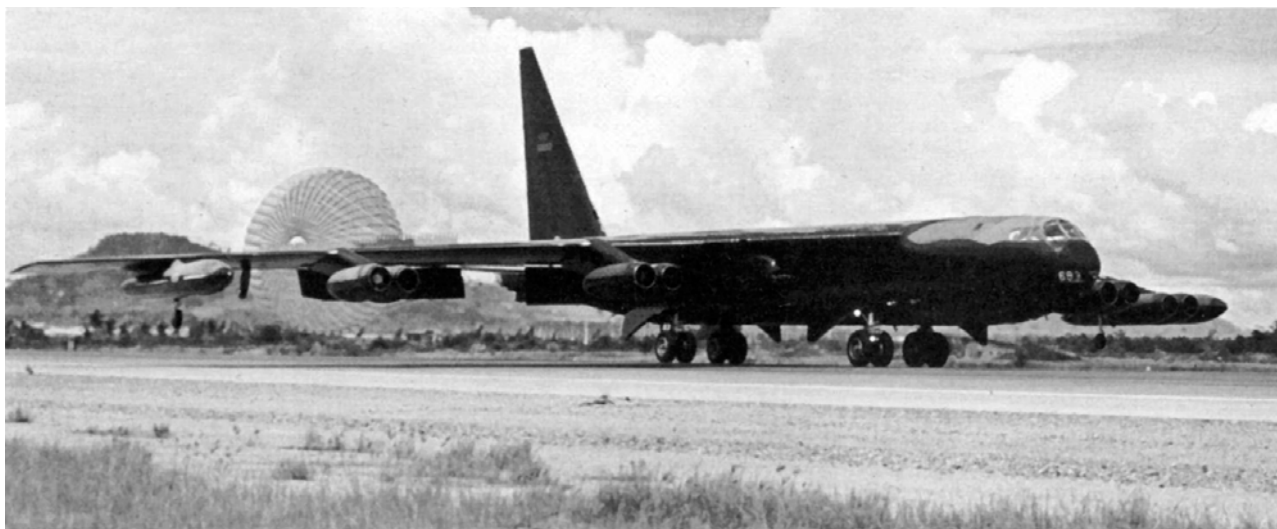
В-52D, выпустив парашют диаметром 13,4 м, выполняет посадку на базе У-Тапао в 1968 г. Это был первый В-52D (56-0693), прибывший на базу, когда U-T стала второй основной базой для В-52 во время операции «Арк Лайт» в апреле 1967 г.
