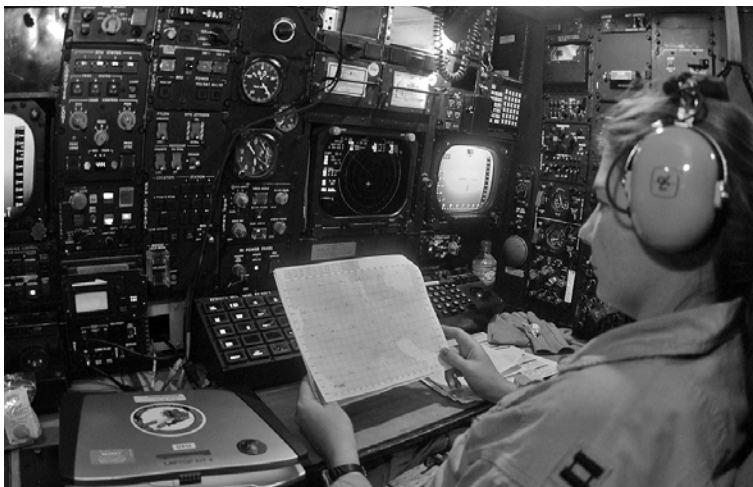
Рабочие места штурмана и штурмана – оператора РЛС на нижней палубе кабины (отверстие ада).
