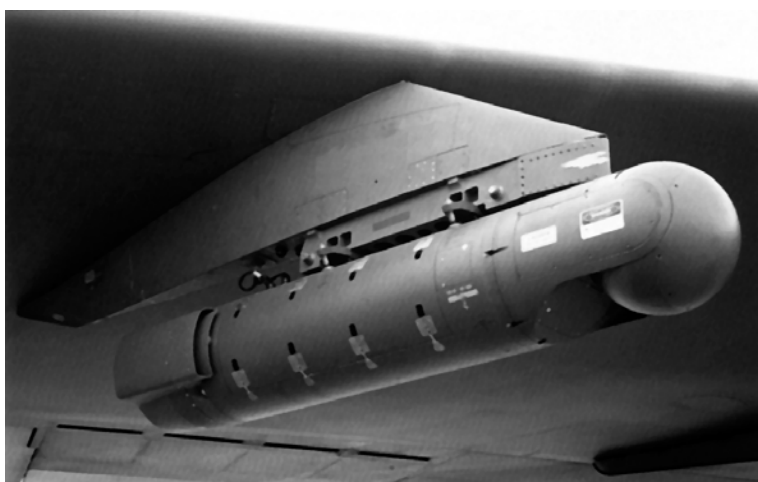
Дополнительный пилон, обычно устанавливается на правом крыле, между пилонами двигателей. На пилоне подвешен лазерный контейнер AN/AAQ-28 Лайтнинг.
