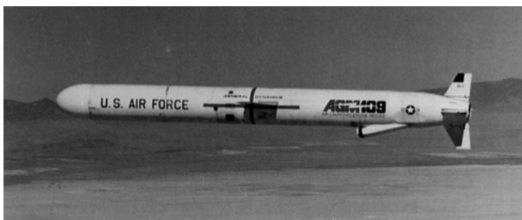
Крылатые ракеты — конкуренты. Вверху: ALCM (AGM-86) (коррекция по рельефу местности) — состоит на вооружении ВВС. Внизу: AGM 109 Томагавк — состоит на вооружении ВМФ.
