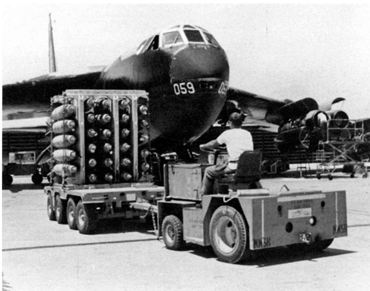
Погрузчик BAT (Bay Assembly Transport) со снаряженным контейнером повышенной плотности В-Bay готовится загрузить самолет В-52D. В данном случае подвешены 28 бомб Mk 82. В самолет помещалось 4 контейнера. Другой тип контейнера вмещал 12 бомб типа M117. В самолет помещалось три таких контейнера.
