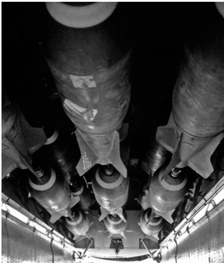
Операция «Буря в пустыне». Бомбы М117 с коническими хвостами в бомбовом отсеке В-52Н, оборудованном системой «Большой живот». Все как во время Вьетнамской войны.
