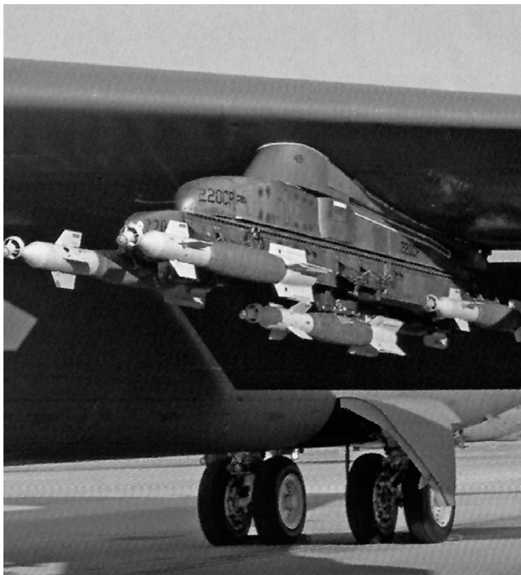
«Лазерные» бомбы GBU-12 под крылом В-52. Для применения бомб необходим контейнер AN/AAQ-28 Лайтнинг.
