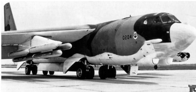
Крылатая ракета General Dynamics AGM-109 была испытана с борта самолета В-52G, но на вооружение ВВС принята не была. Створки бомбоотсека и входной люк экипажа открыты.
