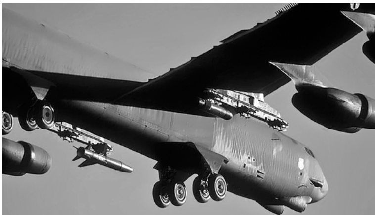
На левом пилоне подвешена ракета AGM-142, а на правом — контейнер управления AN/ASW-55.
