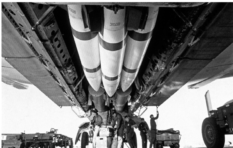
Баллистические ракеты SRAM в бомбовом отсеке B-52. Перед ракетами подвешены водородные бомбы B28.
