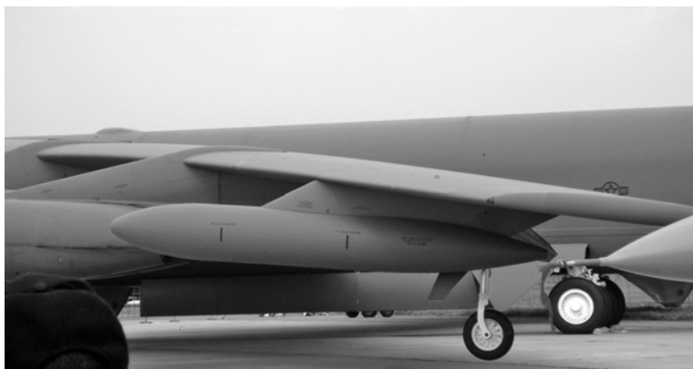
Подкрыльевой бак емкостью 2650 л. Обратите внимание, что бак установлен под углом к продольной оси самолета.
