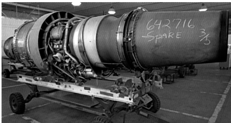
Двигатели В-52 отличаются друг от друга. Мелом написано, что это — 5-й двигатель с 3-го пилона. На двигателе осталась часть капота с выхлопными патрубками для воздуха второго контура.
