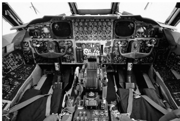
Рабочие места командира и второго пилота. Два экрана перед штурвалами предназначены для отражения информации от прицельно-навигационных систем и от оптической системы EVS.
