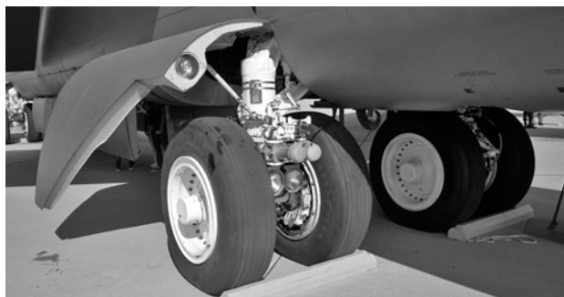
Носовые стойки шасси. На створке и на правой стойке, ниже рулевых машин, установлены посадочные фары.
