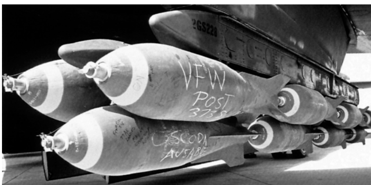
«Операция Буря» в пустыне. Вверху — подвеска бомбы M117R, внизу — бомбы M117 с коническими хвостами на внешней подвеске B-52.
