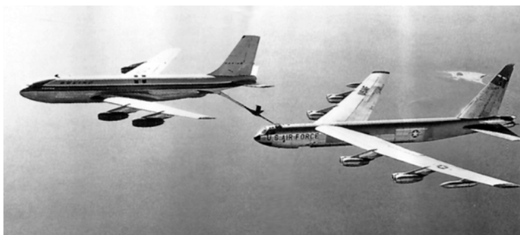
В-52А во время дозаправки с использованием «летающей штанги» системы Боинг. Танкер создан на основе пассажирского Боинга-707.
