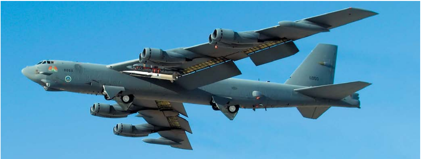
Под крылом летающей лаборатории В-52Н – гиперзвуковой летательный аппарат Х-51А
