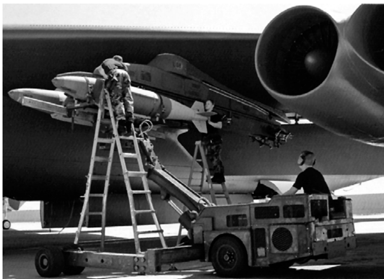
Подвеска управляемой бомбы GBU-31 JDAM на пилон типа HSAB. На каждом пилоне можно подвесить 6 таких бомб.
