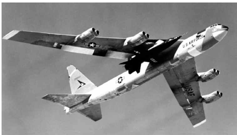
Прежде чем в испытания вступил специальный самолет NB-52B, NB-52A запустил аппарат X-15 93 раза. Обратите внимание на дополнительные иллюминаторы на передней части фюзеляжа и на обтекатель кинокамеры. 1959 г.
