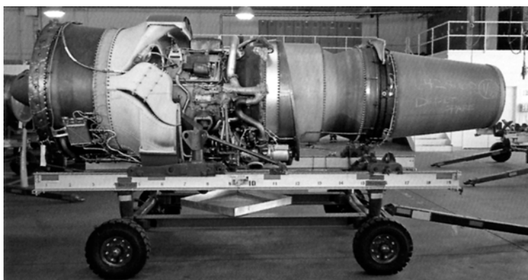
Двигатель без капотов. Обратите внимание на изогнутые воздуховоды возле вентилятора. Средний воздуховод проходит через масляный радиатор. Как американцам удалось пропихнуть воздух через такие крутые повороты — просто удивительно.
