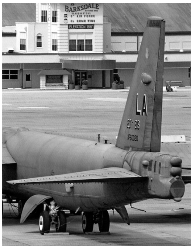
Хвостовая часть В-52Н. Видны задние основные стойки шасси, антенны средств РЭБ на фюзеляже, хвостовое оперение и кормовая часть с антеннами защиты хвоста.
