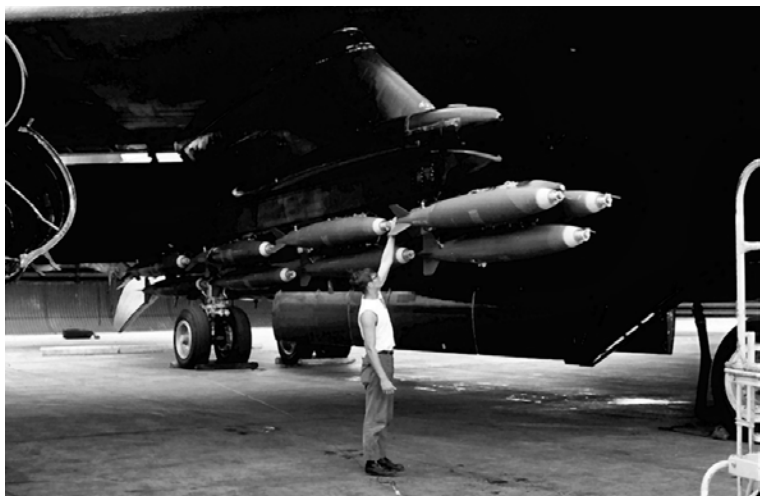
12 бомб Mk 82 под крылом бомбардировщика В-52. Непонятно — бомбы подвешены, а капот двигателя — открыт. Обычно бомбы подвешивают в самый последний момент.
