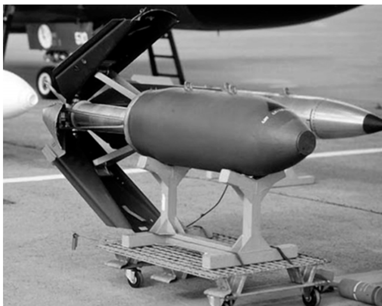
Бомба М117 с раскрытым воздушным тормозом.
