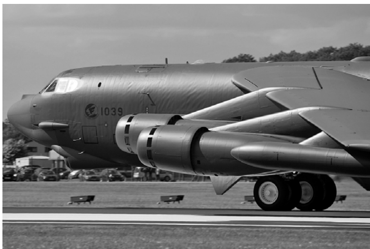
В-52Н на рулении. На крыле хорошо видны два ряда турбулизаторов. Створки дополнительного забора воздуха для двигателей открыты. На внутреннем пилоне двигателя виден воздухозаборник системы кондиционирования. Волнистость обшивки фюзеляжа говорит о том, что конструкция выполнена легкой, гибкой и изящной.
