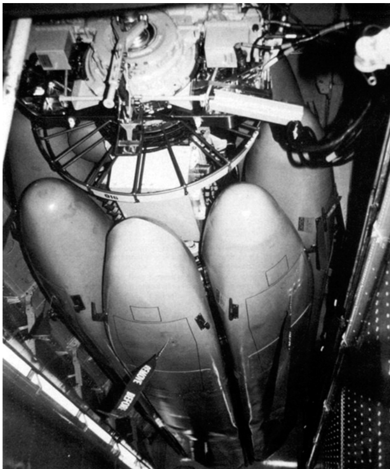
Крылатые ракеты AGM-86B на револьверной пусковой установке CSRL в бомбовом отсеке B-52.
