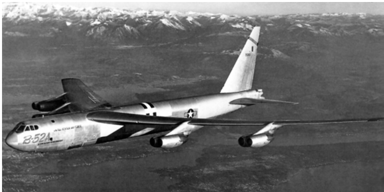
На этом фото видна новая компоновка кабины пилотов. Маркировка, нанесенная на фюзеляже, указывает, что это по-прежнему опытный самолет.
