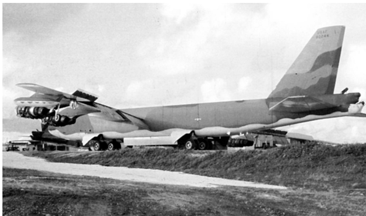
В-52G со снятыми капотами и лючками находится на техническом обслуживании на о. Гуам во время операции «Лайнбакер».
