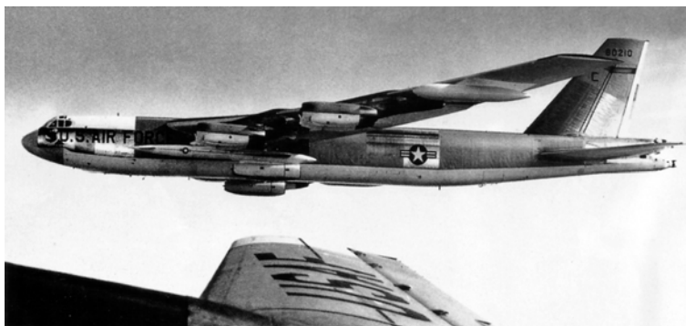
B-52G в полете с ракетами Хаунд Дог под крылом. Двигатели ракет иногда использовались как дополнение к восьми J57 при взлетах с большим взлетным весом. Благо топливо у ракеты и бомбардировщика — одинаковое.
