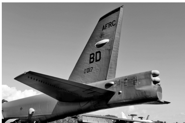
Хвостовое оперение В-52Н. Стабилизатор в нейтральном положении. На нижней поверхности — ряд турбулизаторов, а на законцовке — строевые огни. Рули высоты и поворота имеют маленькую хорду.
