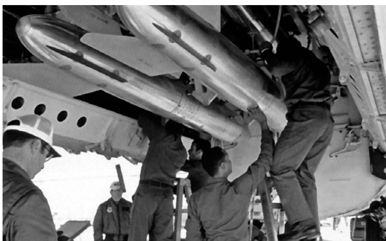
Кассета PWU-9 с четырьмя водородными бомбами В61 в бомбовом отсеке В-52Н.
