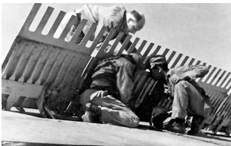
Техническое обслуживание интерцепторов на В-52.
