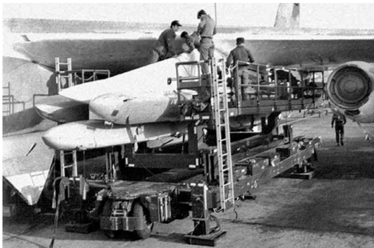
Баллистические ракеты SRAM в бомбовом отсеке В-52. Перед ракетами подвешены водородные бомбы В28.
