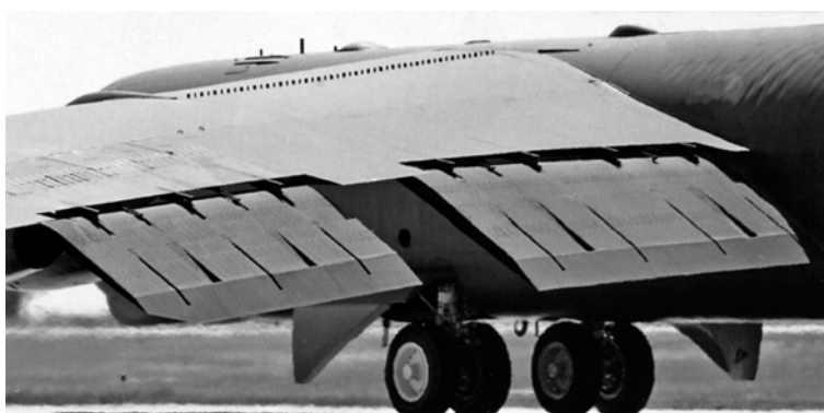
Закрылки выпущены. Сверху виден ряд турбулизаторов. Слева заметны интерцепторы.
