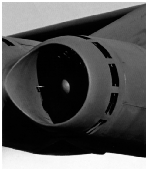
Воздухозаборник с «губой» и створками для дополнительного забора воздуха.
