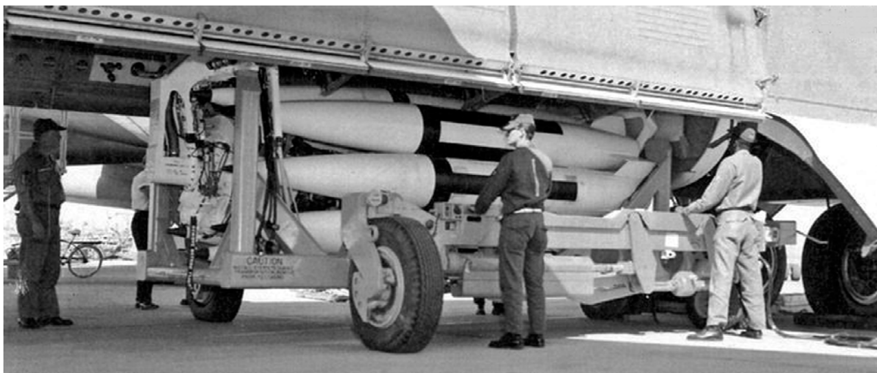
Загрузка ракет SRAM на бомбардировщик B-52G.
