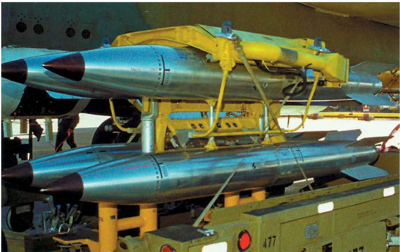
Четыре водородные бомбы В-61 в бомбовой кассете PWU-9
