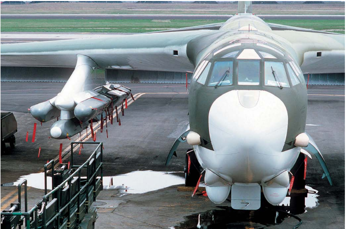
Бомбардировщик В-52G. На ядерном пилоне подвешены крылатые ракеты AGM-86В. Обратите внимание: между центропланом и фюзеляжем установлены зализы
