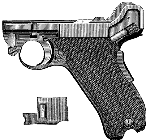
1.15. Рамка с рукояткой в сборе и спусковая крышка
