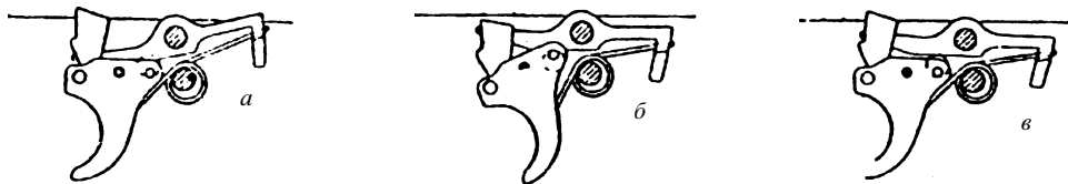
14.16. Положение деталей спускового механизма:
