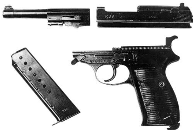
3.17. Части пистолета «Вальтер» Р-38 при неполной разборке
