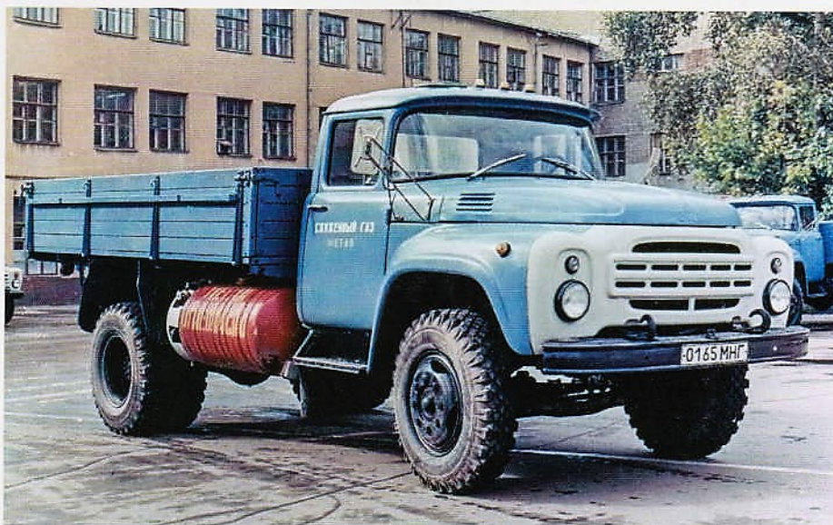
Газобаллонный грузовик ЗИЛ-138П, предназначенный для работы на сжиженном метане
