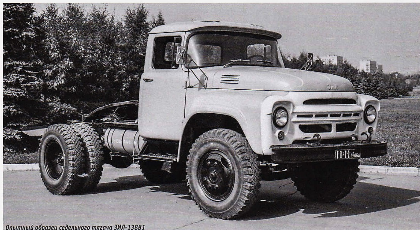
Опытный образец седельного тягача ЗИЛ-138В1
