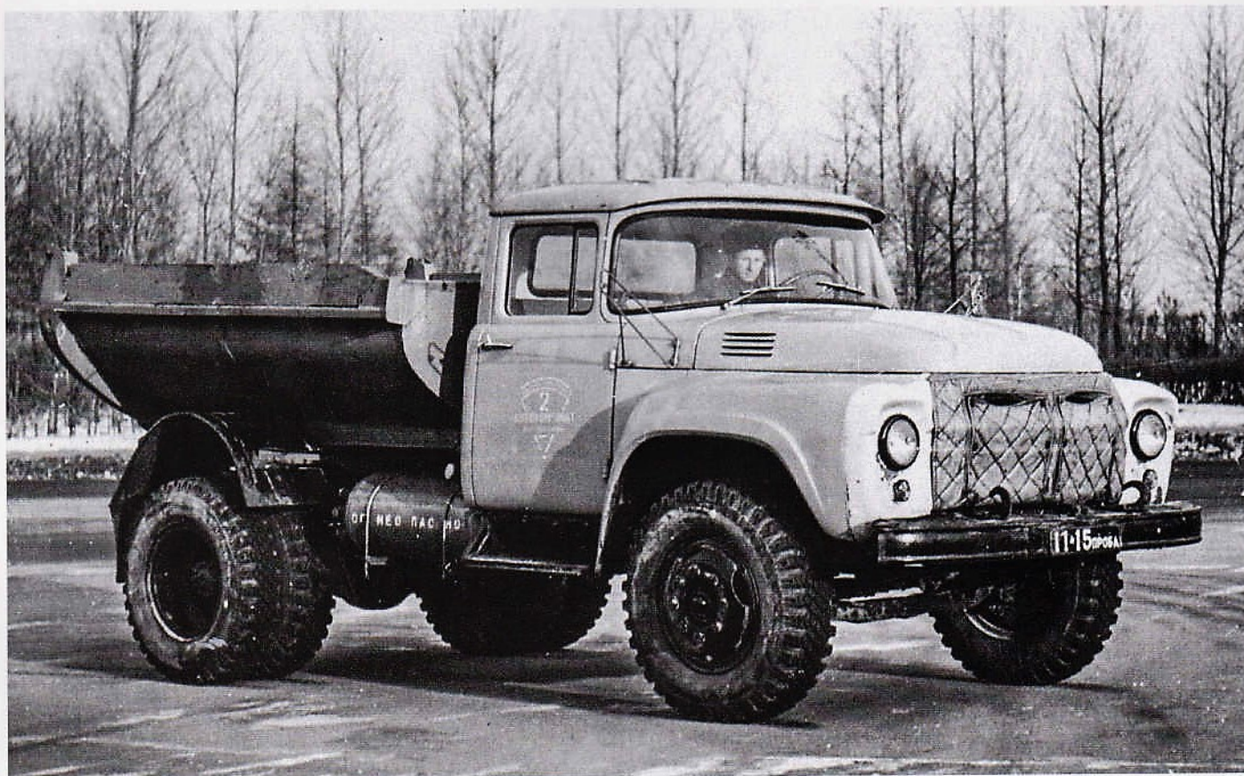
Самосвал ЗИЛ-ММЗ-555 на опытном шасси ЗИЛ-138Д1
