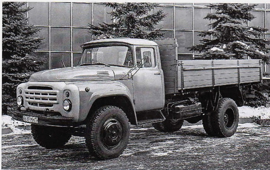
Газобаллонный грузовик ЗИЛ-138А, предназначенный для работы на сжатом природном газе
