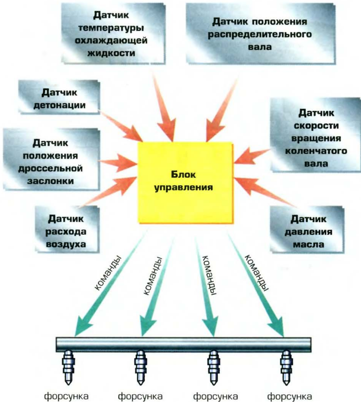
Рис. 20. Принцип работы бортового компьютера.
